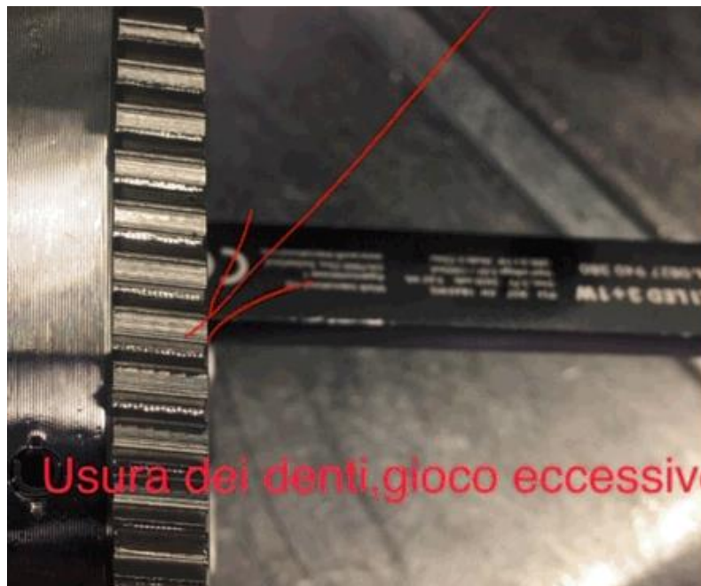
Figura 4.22: usura e gioco eccessivo dei denti di CA4
