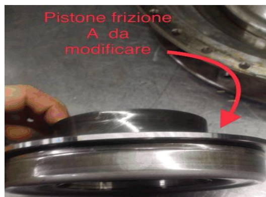
Figura 4.20: pistone da modificare di CA3
