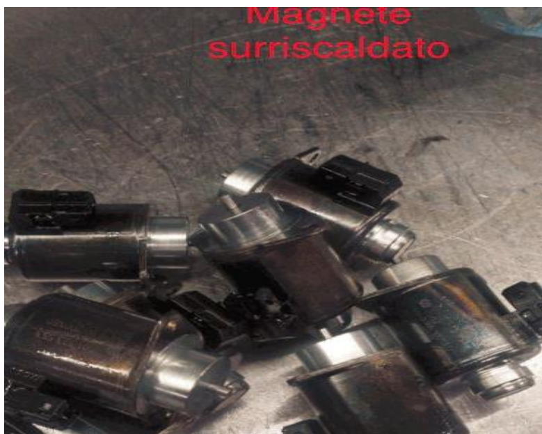
Figura 4.23: magnete surriscaldato di CA4
