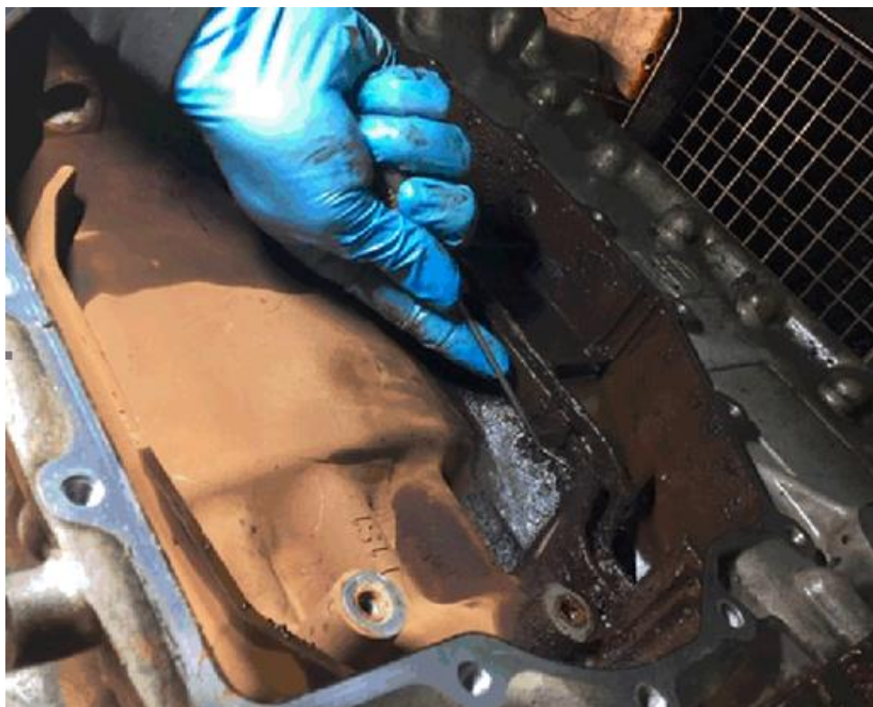
Figura 4.16: innesco di corrosione sulla scatola del cambio di CA2
