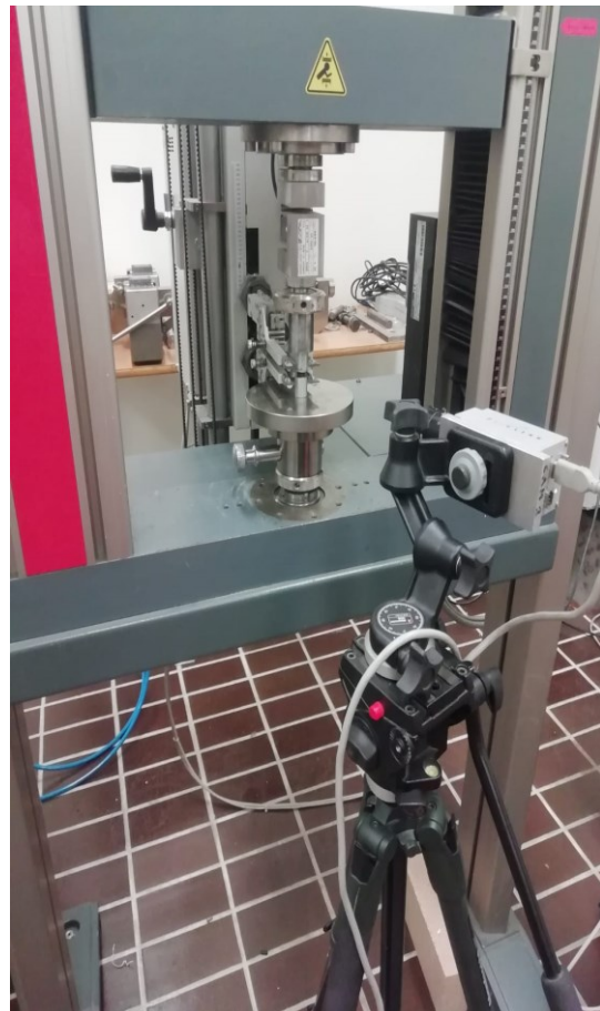
Figura 20 e 21 - Macchina prova a compressione statica
