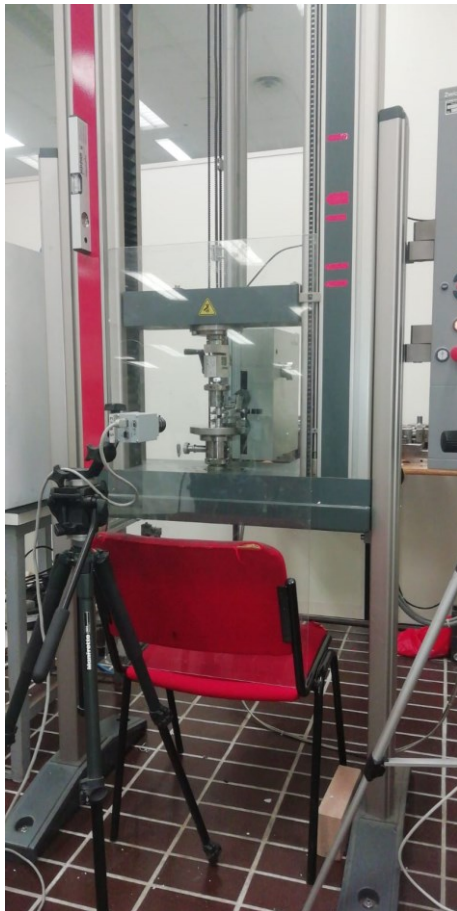
Figura 20 e 21 - Macchina prova a compressione statica
