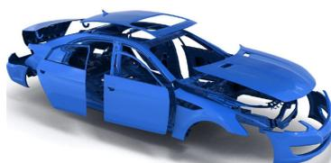
Figura 1.1: *Esempio di stampaggio di lamiera nel settore automobilistico*
