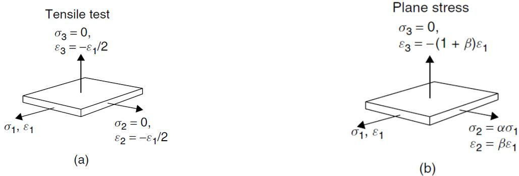
Figura 1.2: *Tensioni e deformazioni principali per elementi che si deformano in (a) trazione uniassiale e (b) in un processo generale di tensione piana su una lamiera*
