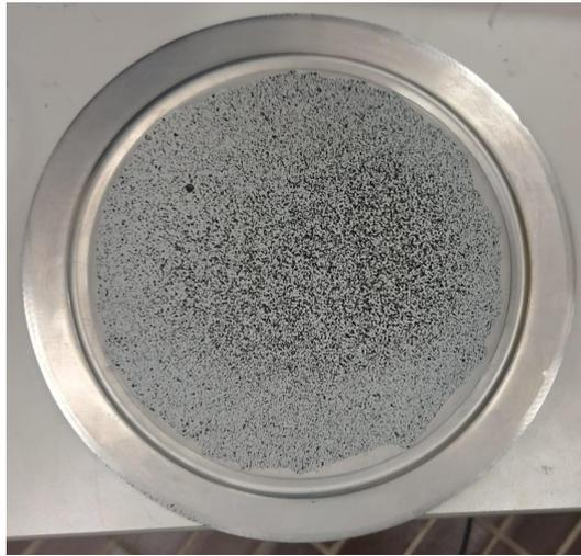
Figura 2.3: *Tecnica dello Speckle*
