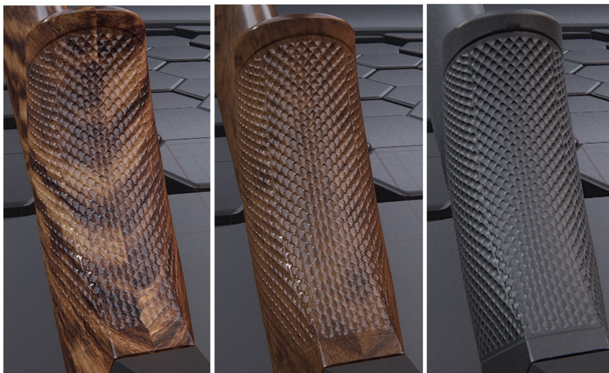
Figura 5-4: Confronto visibilità della discontinuità in corrispondenza della seam sull'impugnatura del calcio con materiali differenti: A sinistra: materiale disomogeneo, seam molto visibile; Al centro: discontinuità poco visibile; A destra: materiale omogeneo, seam non visibile
