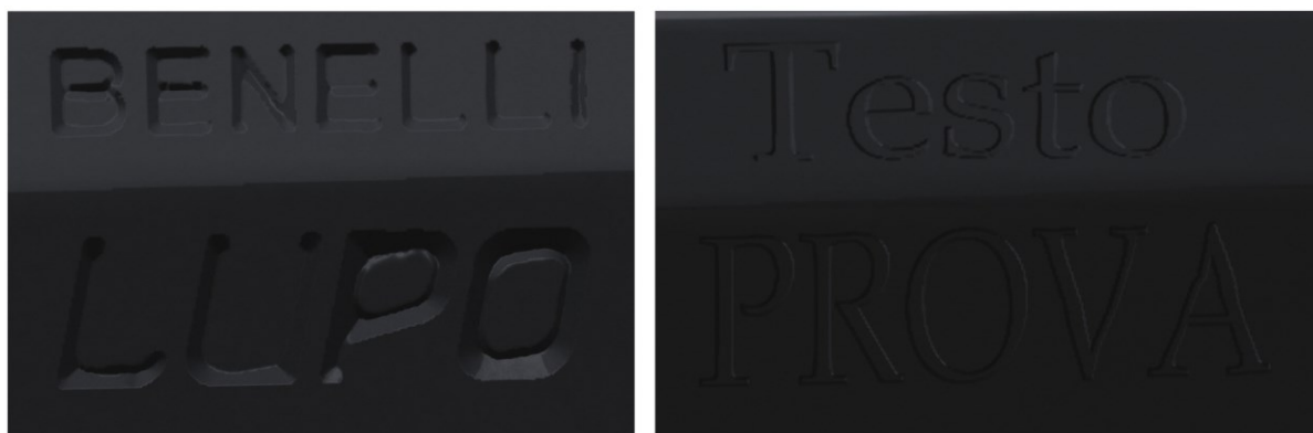
Figura 5-3: Confronto tra qualità della scritta incisa se ottenuta con baking semplice (sinistra), o sostituita (destra)
