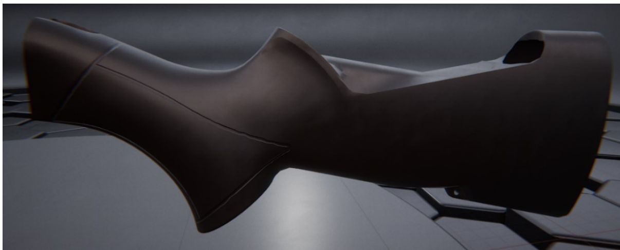
Figura 3-13: Scanalatura leggermente deformata in Unreal a causa della triangolazione del modello
