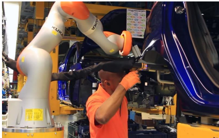
Figura 3.4: Cobot realizzato da KUKA Roboter GmbH, utilizzato per installare ammortizzatori su Ford Fiesta.
