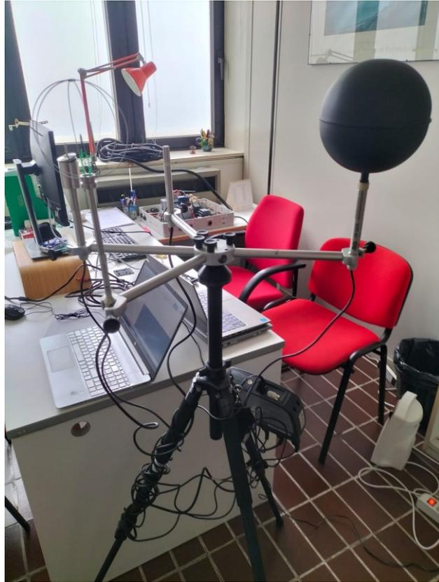
*Figura 23: installazione della stazione microclimatica*
