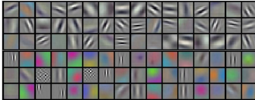
Figura 3.4: Set di 96 filtri 11 \times 11 \times 3 appresi dall'architettura di Krizhevsky et al. (2012) in un problema di classificazione di immagini. L'assunzione di weight sharing è ragionevole dal momento che individuare una linea o uno spigolo è importante in qualsiasi posizione dell'immagine, e di conseguenza non c'è la necessità di imparare ad localizzare la stessa caratteristica in tutte le possibili zone.
