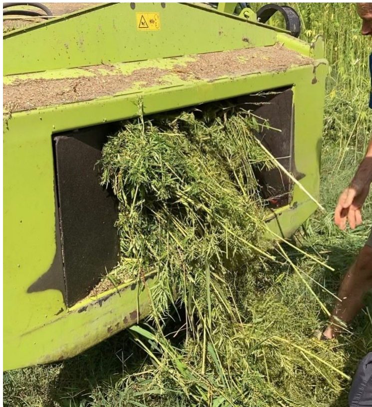
Figura 2-32: lamiera poste a restringere il canale che porta al battitore, come protezione ai cuscinetti
