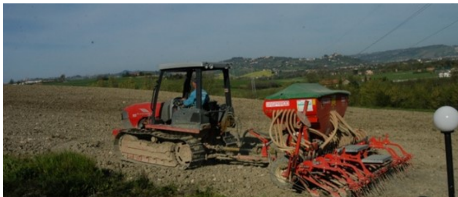
Figura 1-28: seminatrice pneumatica per semina canapa
