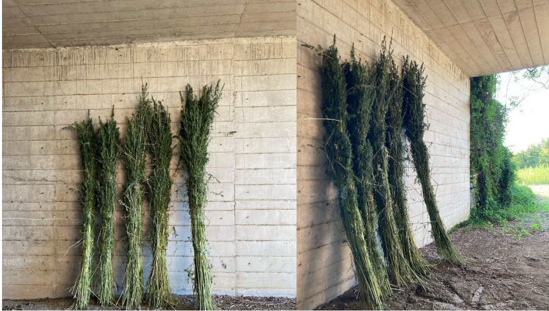
Figura 2-9: le 5 fascine della seconda prova di macerazione sotto il ponte (seconda prova)
