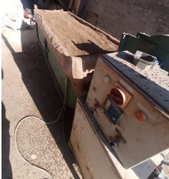
Figura 1-55: essiccatoio orizzontale a flusso d'aria
