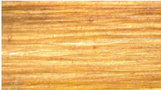
Figura 2-26: stelo della terza prova; visibili fasci di fibra nella parte mediana dello stelo
