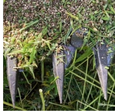
Figura 2-31: lame a sezione trapezoidale
