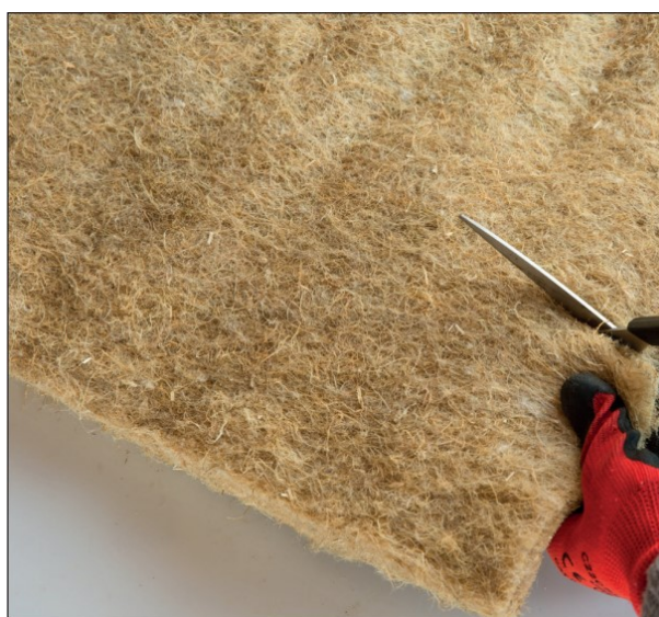
Figura 1-22: pannelli isolanti (da Ranalli, 2020)
