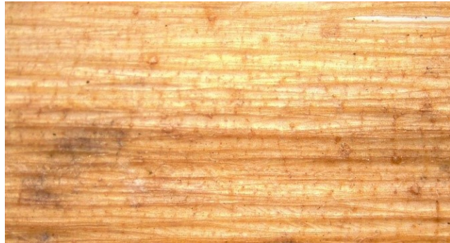
Figura 2-27: stelo della terza prova; visibili fasci di fibra nella parte basale dello stelo
