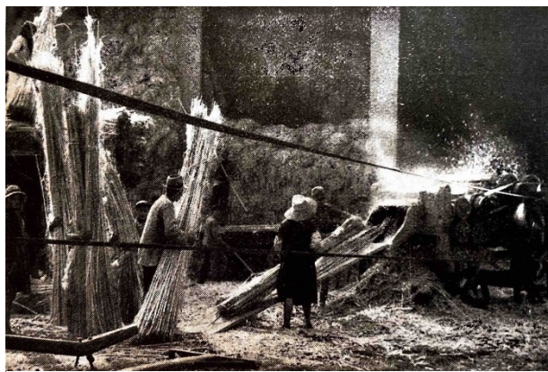
Figura 1-49: scavezzatrice all’opera (da Ragazzi, 1954)
