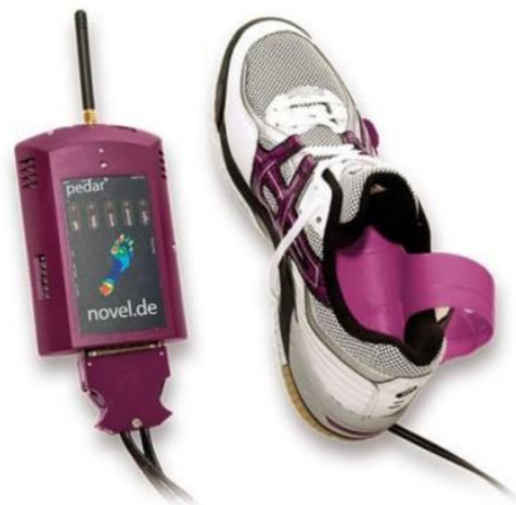
Fig. 7 - Un sensore di pressione plantare del piede inserito nella scarpa Pedar Novel
