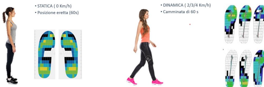
Fig. 23 - Protocollo acquisizione dati con matrici di sensori di pressione
