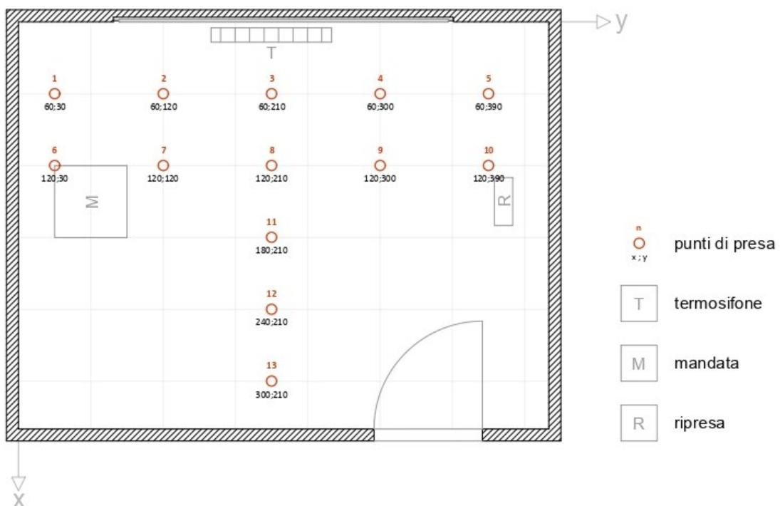
Fig.13. Pianta della test-room con individuazione dei punti di presa.
