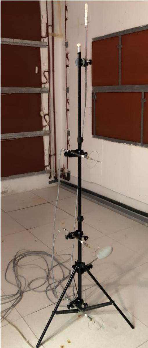
Fig.24. Foto strumento ComfortSense Dantec.
