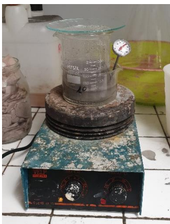
Figura 3.4 – miscelazione LCD con H 2 SO 4
