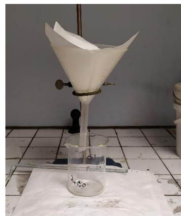
Figura 3.6 – filtrazione LCD con H 2 SO 4
