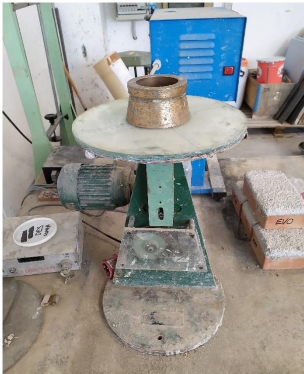
Figura 3.38 – Apparecchiatura per lo slump-flow test
