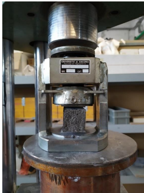
Figura 3.40- Provino sottoposto a rottura a compressione
