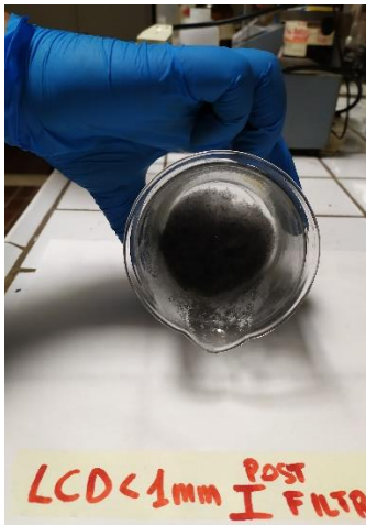
Figura 3.10 – LCD post 1° filtrazione e lavaggio con acqua
