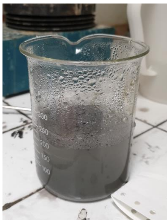
Figura 3.5 – LCD con H 2 SO 4
