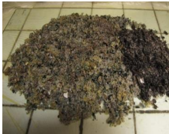
Figura 3.13 – LCD mantenuto in acido
