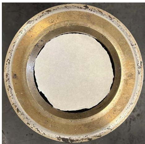
Figura 6.8 – Disco in carta disposto sulla sommità del materiale da compattare
