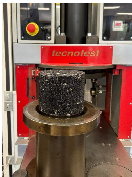
Figura 6.12 – Provino estratto dalla fustella mediante martinetto pneumatico
