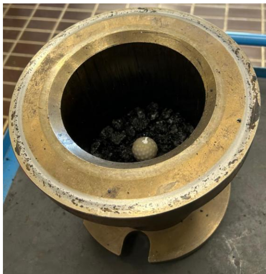
Figura 6.25 - Dettaglio di come il sensore viene orientato rispetto alla fustella
