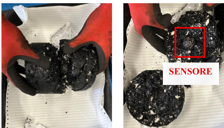
Figura 6.29 – Fase di rottura del provino (A) ed estrazione del sensore (B)
