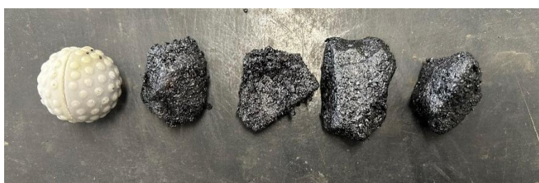
Figura 3.2 – Confronto tra le dimensioni del guscio sferico e quelle di un aggregato di maggiore pezzatura
