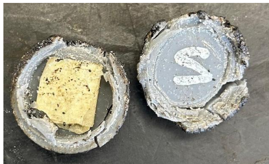
Figura 6.21 – Condizione del guscio protettivo a seguito della fase di compattazione: è possibile osservare l'applicazione del nastro biadesivo, impiegato al fine di garantire la solidarizzazione del sensore con il guscio stesso.
