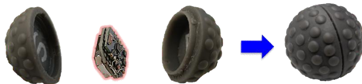
Figura 3.1 – Composizione aggregato intelligente
