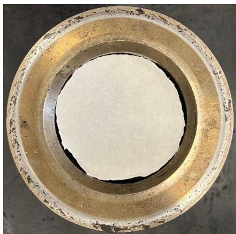
Figura 6.28 – Posizionamento del secondo disco di carta sulla sommità del materiale
