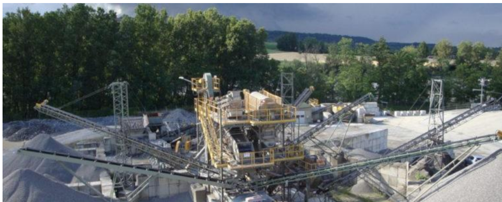
Figura 2.11 – Fase di vagliatura e stoccaggio degli aggregati
