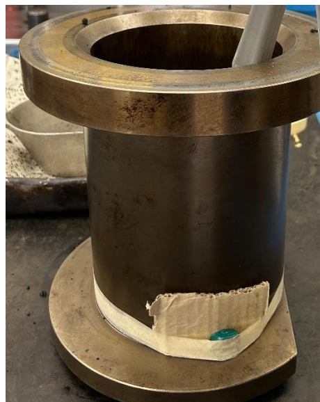
Figura 6.10 – Posizionamento del sensore esterno alla fustella con interposizione di uno strato di cartone e fissaggio mediante nastro carta
