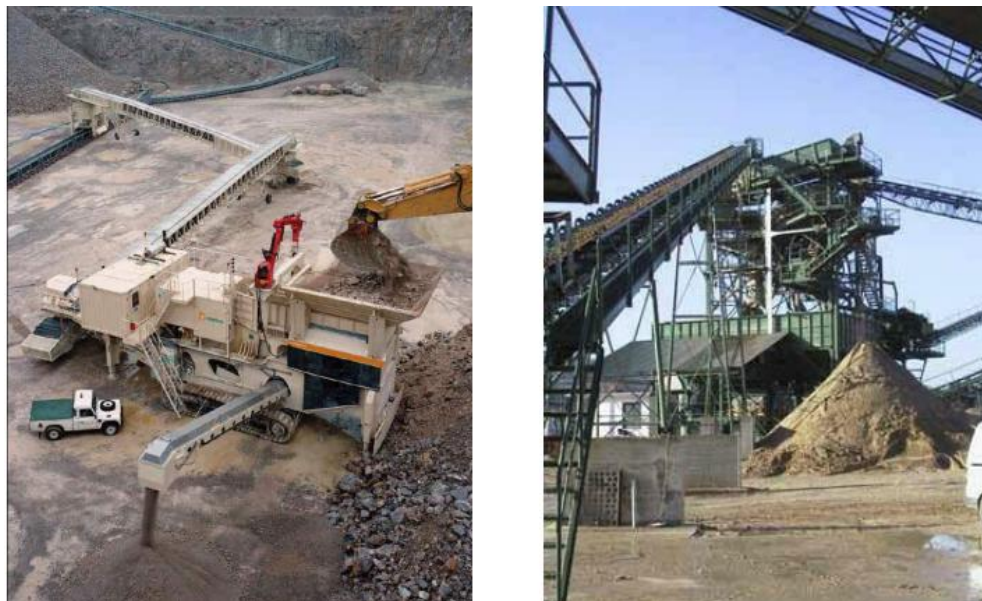
Figura 2.10 – Fase di frantumazione degli aggregati provenienti dalla cava
