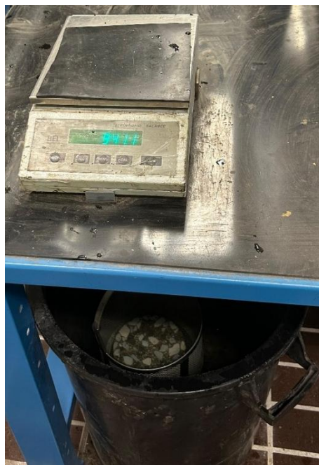
Figura 6.18 – Processo di pesatura mediante pesa idrostatica
