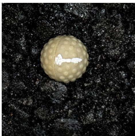
Figura 6.22 – Dettaglio della marcatura recante l'indicazione dell'asse verticale Z (evidenziato mediante un punto) e della direzione dell'asse orizzontale X (indicato tramite un segmento).
