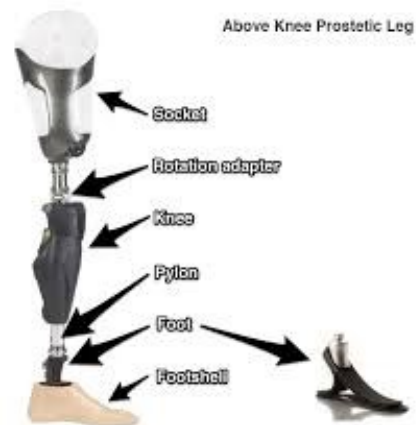
Figura 4: Le componenti della protesi transfemorale. Fonte: Sconosciuta
