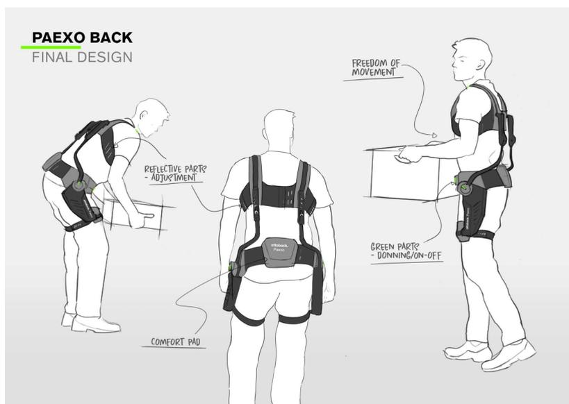
Figura 3.1: L'esoscheletro passivo PAEXO Back, sviluppato dalla Ottobock.
