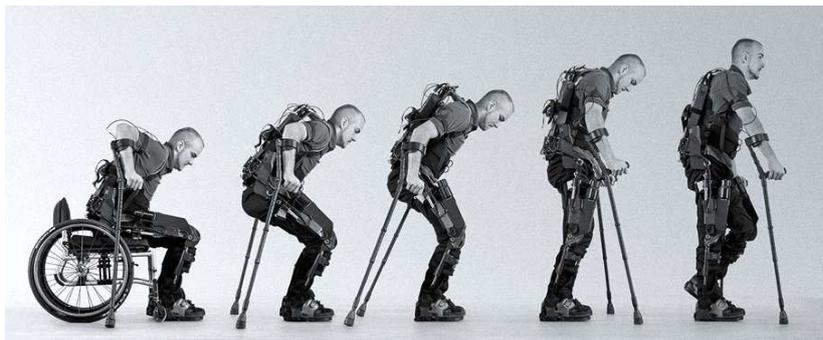
Figura 2.2: Esoscheletro medico Ekso GT, sviluppato dalla Ekxo Bionics.
