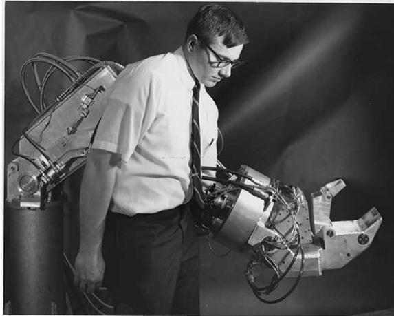
Figura 2.1: Dettaglio della mano dell'esoscheletro attivo Hardiman.
