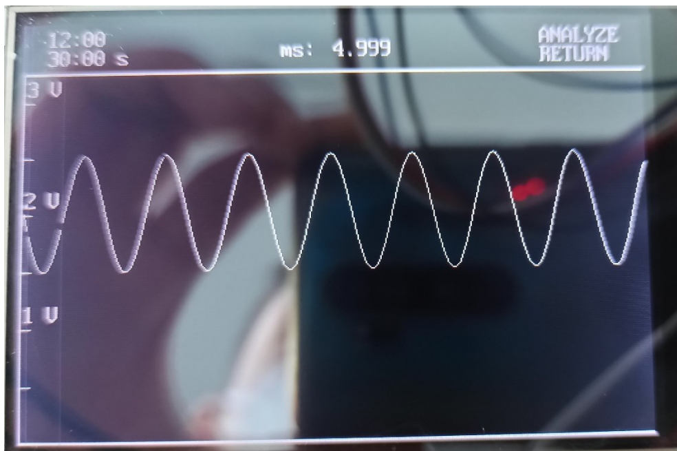
Figura 15: Schermata di analisi con segnale in ingresso sinusoidale 1V a 200Hz
