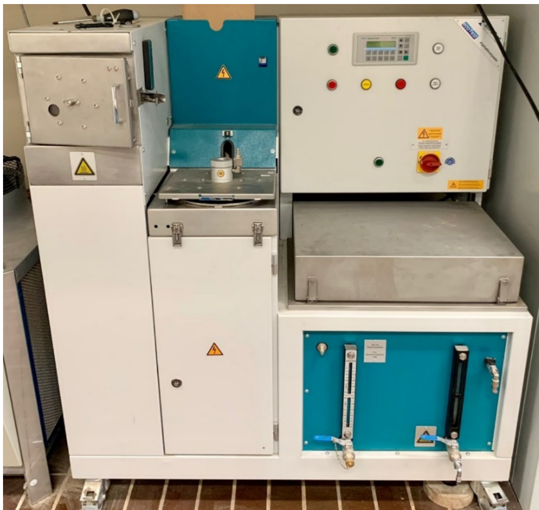
Figura 2.11 Macchinario per estrazione bitume Infratest
