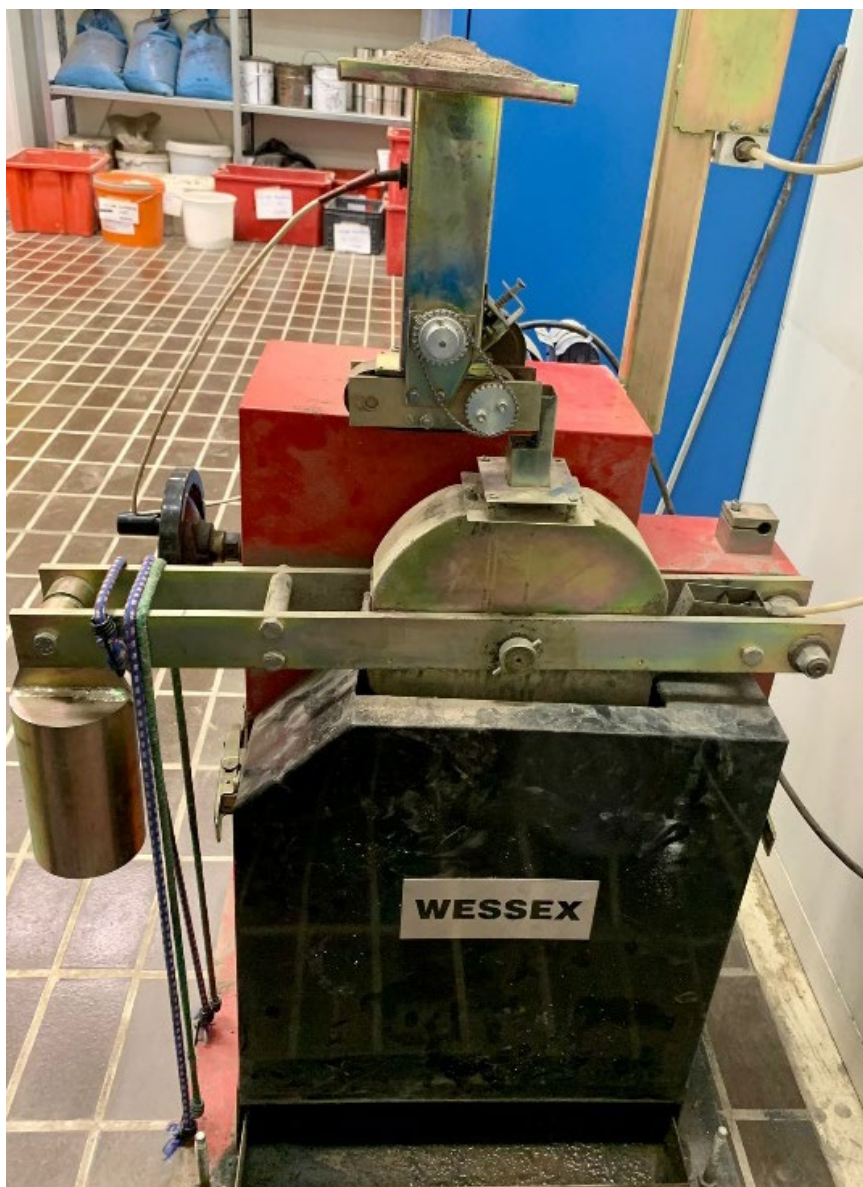
Figura 2.9 Macchinario per prova CLA
