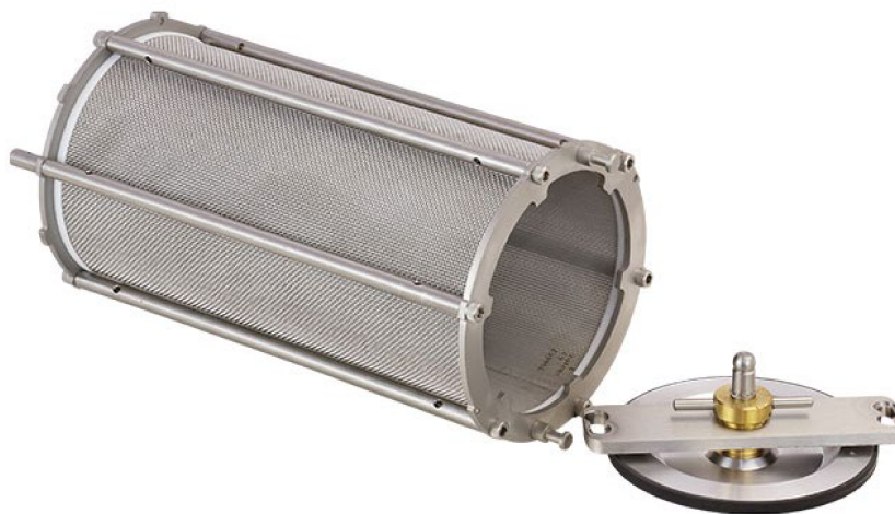
Figura 3.4 Cestello dell'estrattore di bitume Infratest con coperchio
