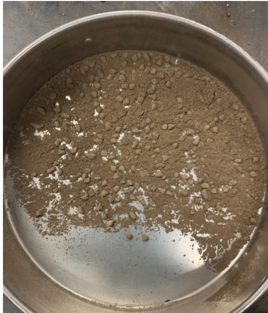
Figura 3.2 Frazione 0/4 del materiale che è stato trattato con prova micro-Deval (fino prodotto)
