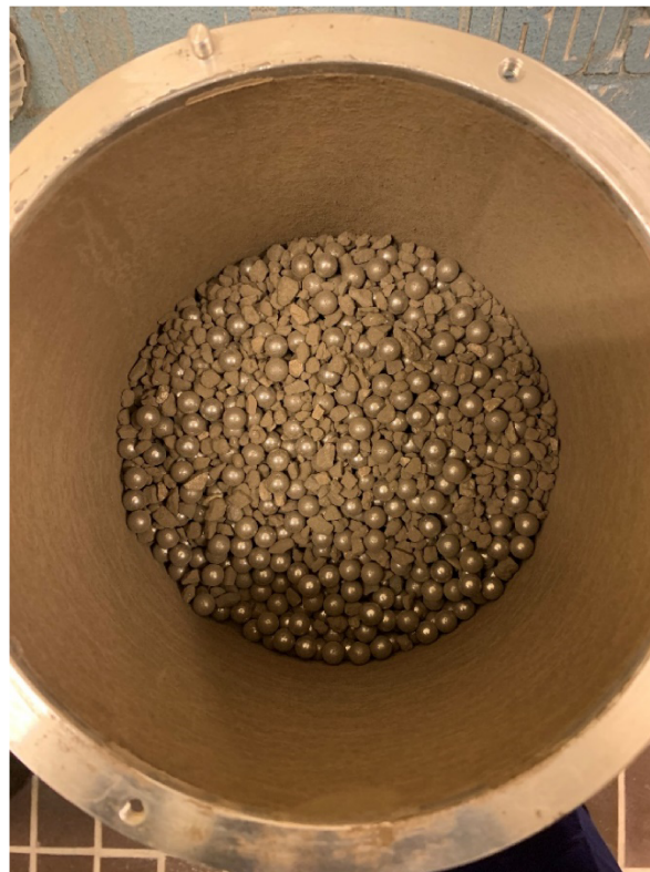
Figura 2.8 Tamburo Micro-Deval con all'interno materiale oggetto di studio e carica abrasiva
