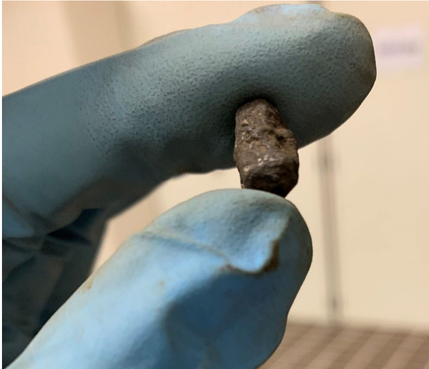
Figura 4.5 Esempio di granulo con forma regolare quindi classificabile come granulo cubico, il cui rapporto tra il lato maggiore e quello minore è sicuramente minore di 3
