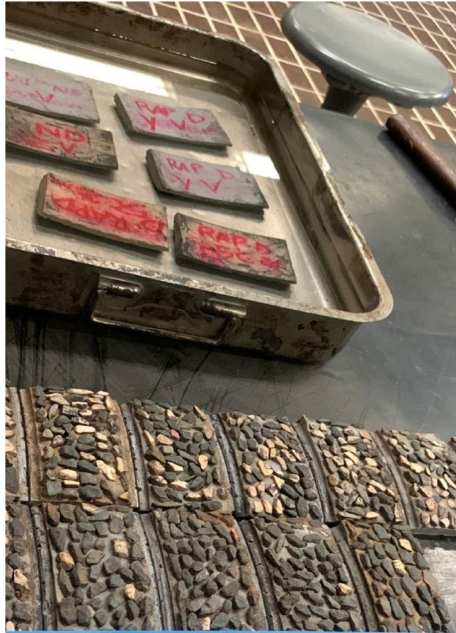
Figura 3.3 In basso alcuni provini sottoposti alla prova CLA, in alto provini immersi in acqua a con la faccia rivolta verso il basso
