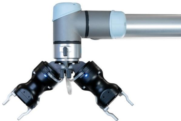
**Figura 6.13** Possibile soluzione con doppia pinza.
