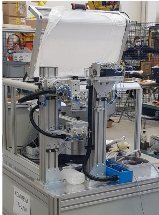
**Figura 3.79** Stazione di predisposizione delle guarnizioni e successivo assemblaggio sullo scambiatore
