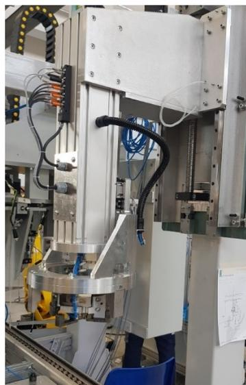
Figura 3.38 Seconda stazione di inserimento del coperchio dello scambiatore di calore
