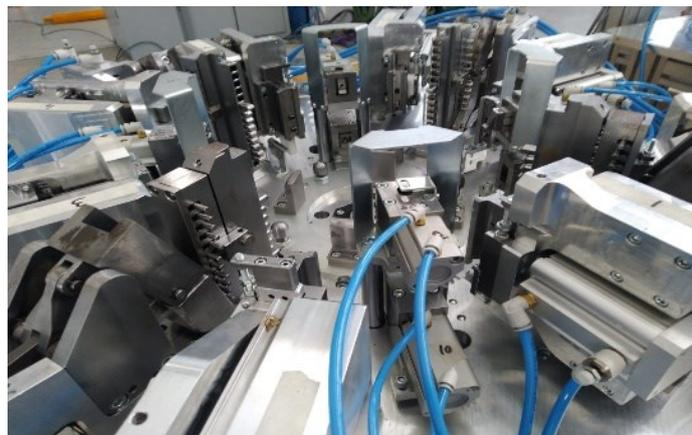
Figura 3.7 Stazione centrale di posaggio
