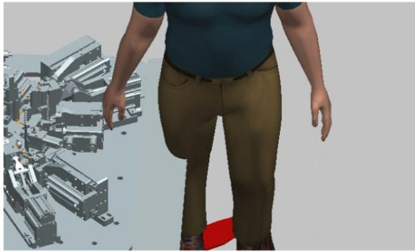
**Figura 3.30** Interferenza del Jack con il banco durante il movimento
