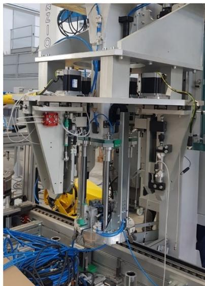
Figura 3.56 Terza stazione di ancoraggio del coperchio tramite griffe di tenuta
