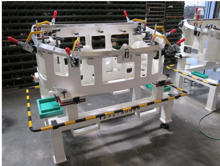
**Fig.8: Generico Calibro di controllo**
