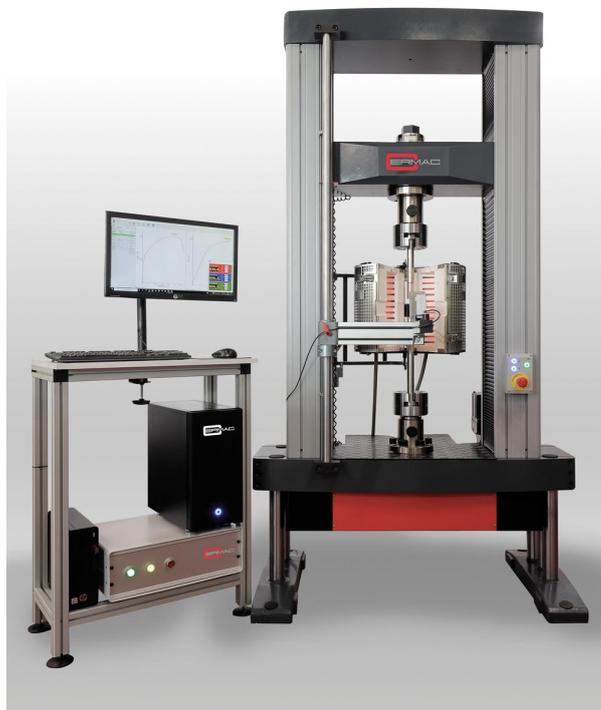
Figura 1.7: esempio di macchina per prove meccaniche
