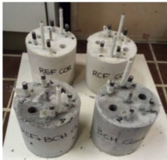
Fig.5.2.8: i provini dopo la scasseratura.
