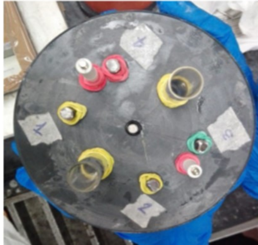
fig.5.2.3: assemblaggio delle barre di armatura, degli elettrodi di riferimento e dei contro elettrodi al coperchio superiore del campione a cilindro.
