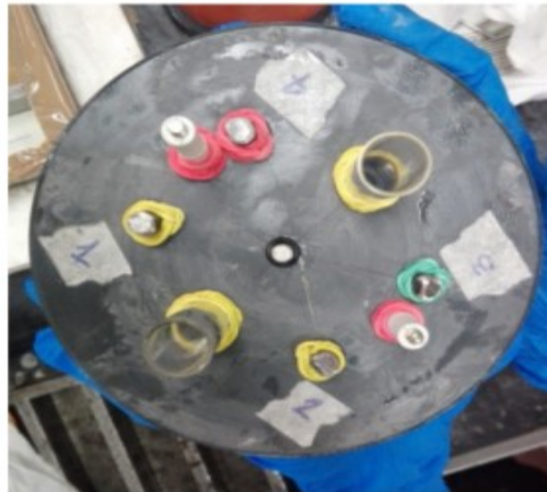
Fig5.2.6: Assemblaggio delle barre di armatura, degli elettrodi di riferimento e dei controelettrodi al coperchio superiore del campione a cilindro.
