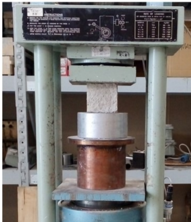
Fig.6.2.3. Posizionamento del provino all'interno della pressa.
