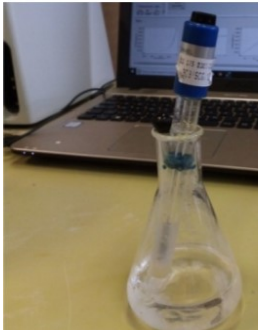
Fig.5.2.4: elettrodo al calomelano saturo immerso in una soluzione di KCl
