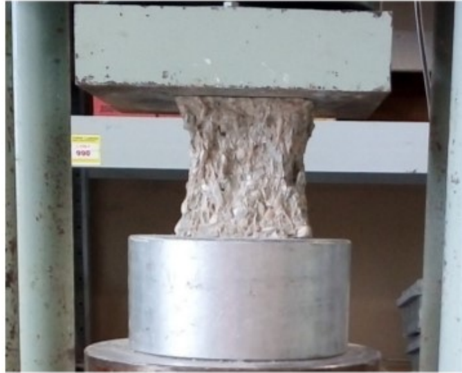
Fig.6.2.4. Rottura del provino con forma a “clessidra”
