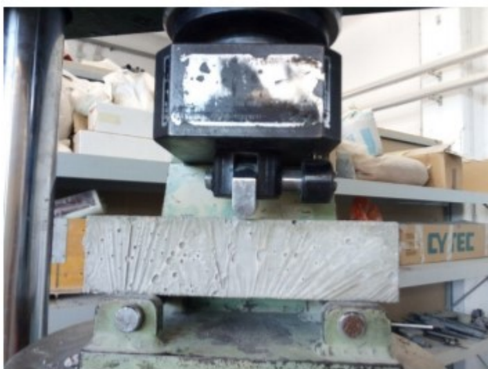
Fig.6.1.3. Posizionamento del campione nella pressa.
