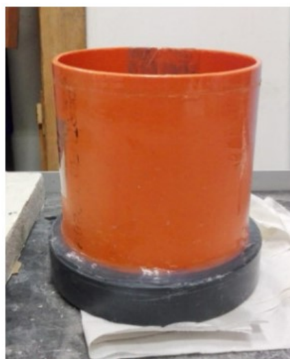
fig.5.2.2: tubo in PVC sigillato con il coperchio inferiore
