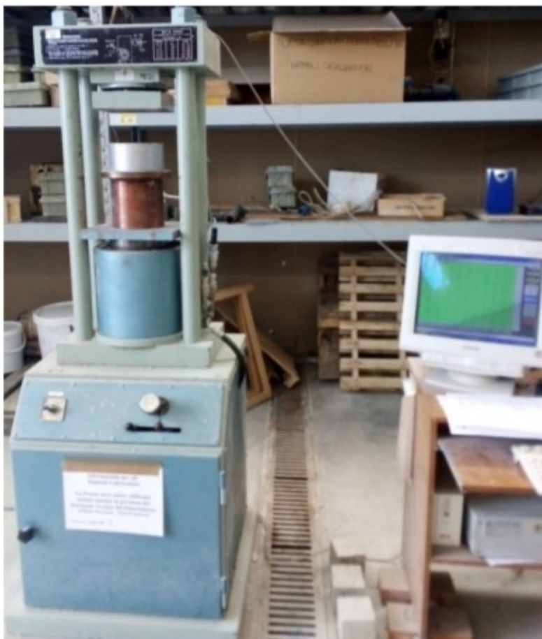
Fig.6.2.1. Pressa utilizzato per la prova di schiacciamento sui provini di calcestruzzo.
