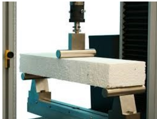
Fig.6.1.1: prova di flessione a tre punti.
