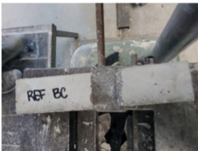
Fig.6.1.4. Rottura del provino sottoposto alla prova a flessione.
