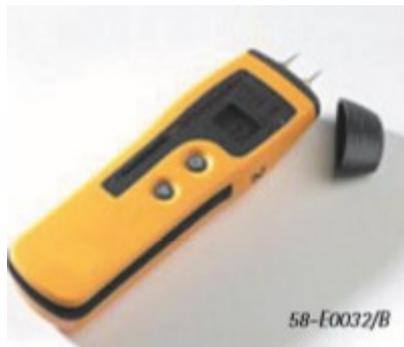
Figura 6. LI9200 misuratore di umidità
