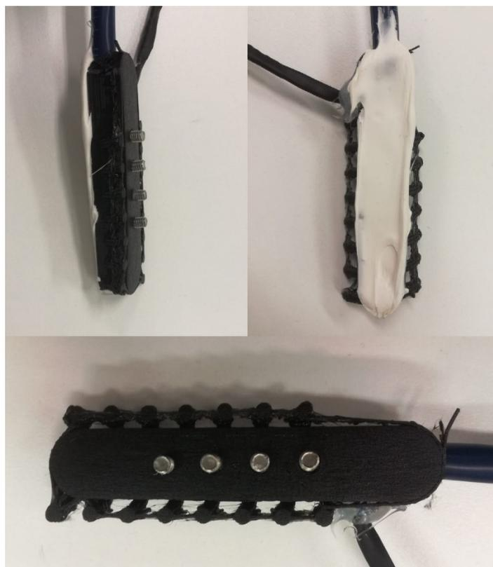
*Figura 17. Case realizzato in stampa 3D contenente gli elettrodi. In alto a sx: resina bianca utilizzata per impermeabilizzare la zona inferiore.*
