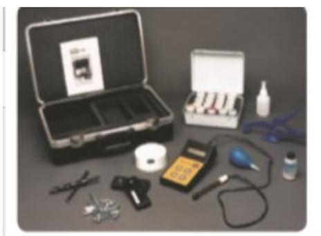
Figura 5. 58-E0064: Corredo per la misura in sito del contenuto di cloruri nel calcestruzzo
