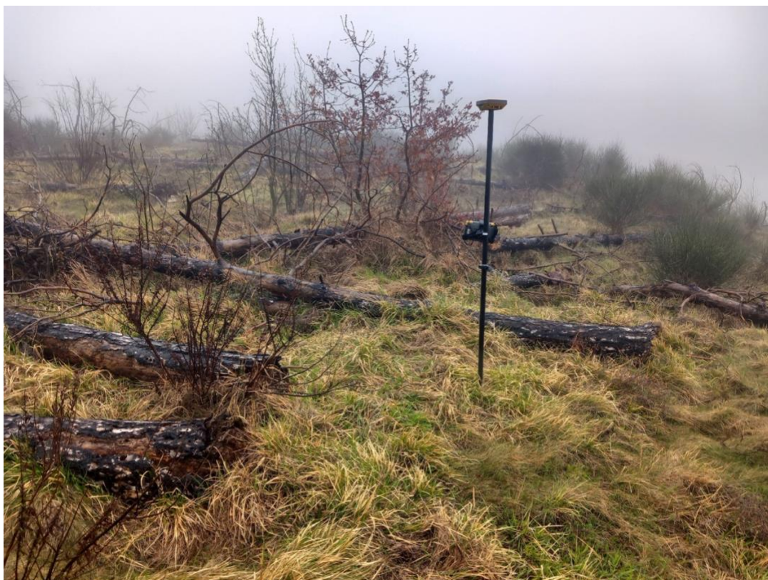
Fig. 23 Posizionamento ricevitore GNSS in corrispondenza del centroide del plot per la registrazione della posizione con accuratezza centimetrica
