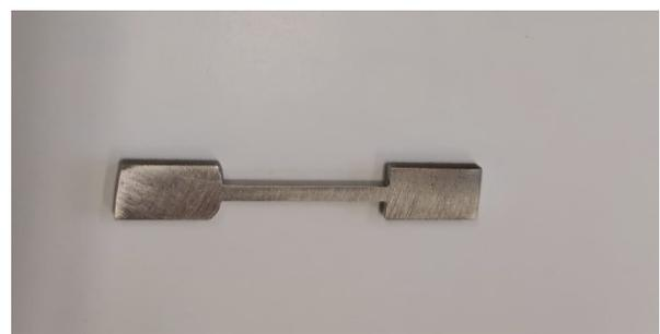
**Figura 3.1 (b)** – foto del campione dopo la lucidatura
