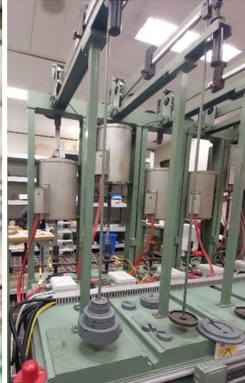
**Figura 4.3 (c)** – foto del sistema di applicazione dei pesi
