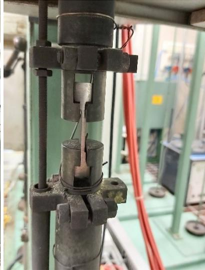
**Figura 4.3 (b)** – foto del campione montato
