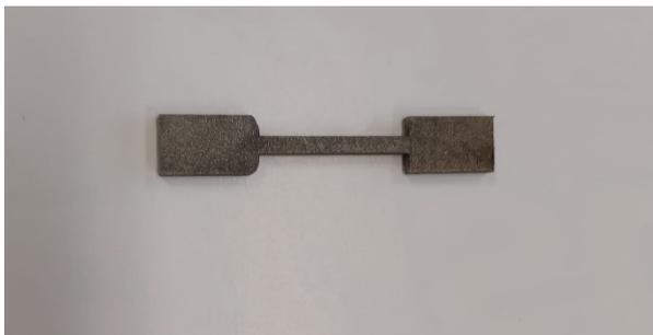
**Figura 3.1 (a)** – foto del campione prima della lucidatura
