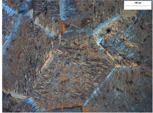
**Figura 4.6 (b)** - microstruttura della lega Ti-6Al-4V al MO con obiettivo 10x0,8
