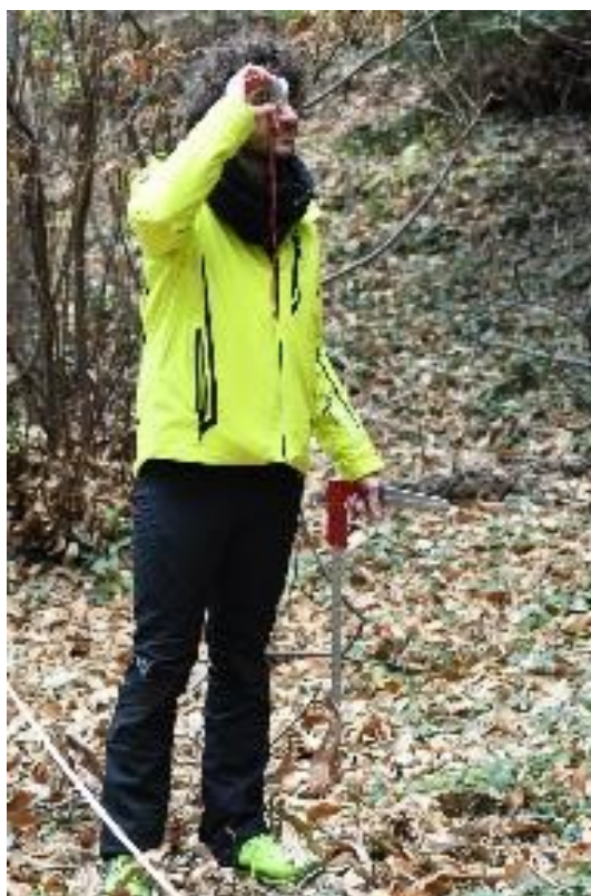
Fig. 2.2.2.1 Cavalletto e ipsometro utilizzati per il rilevamento dei parametri dendrometrici degli individui di abete bianco nei siti dei dintorni di Ascoli Piceno.
