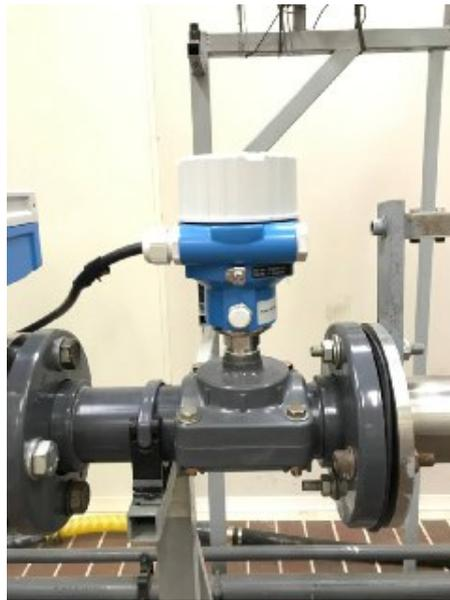
Figura 3.3: Sensore Pressione LN7
