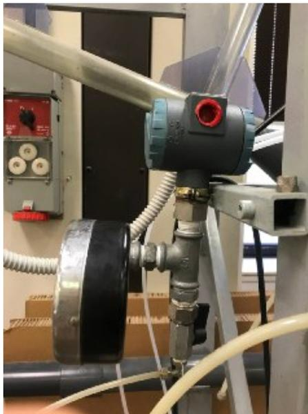
Figura 3.1: Sensore Pressione LN12
