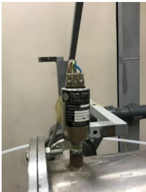
Figura 3.13: Sensore Pressione LN11
