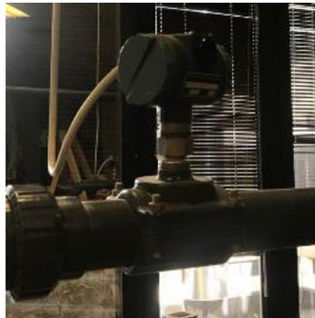
Figura 3.9: Sensore Pressione LN19
