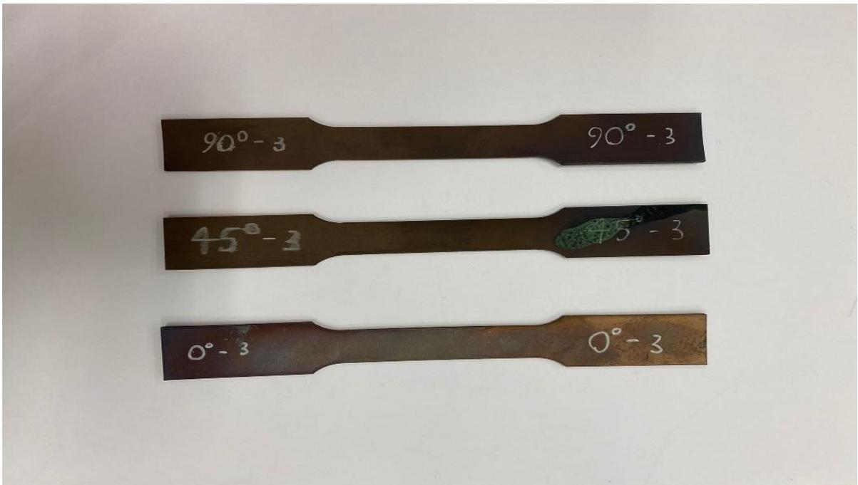
*Figura 23-Provini con larghezza del filamento di 0.25mm e orientazioni differenti dopo essere stati sottoposti a trattamento termico H900.*
