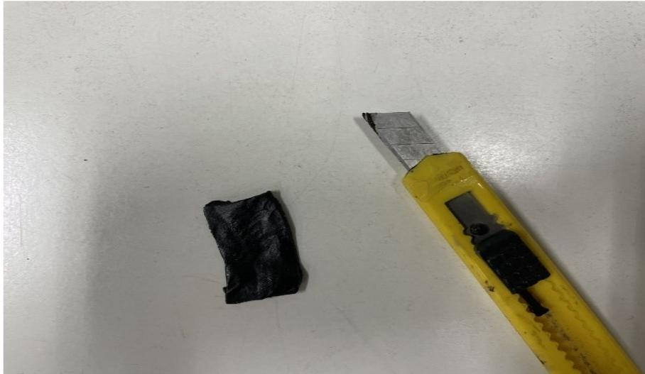
*Figura 4.9 – Provini da inserire nel DSR*
