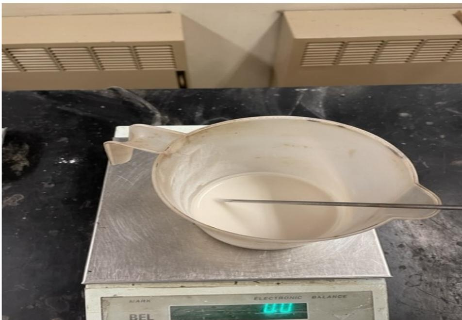
*Figura 4.3 – Contenitore con filler e acqua*
