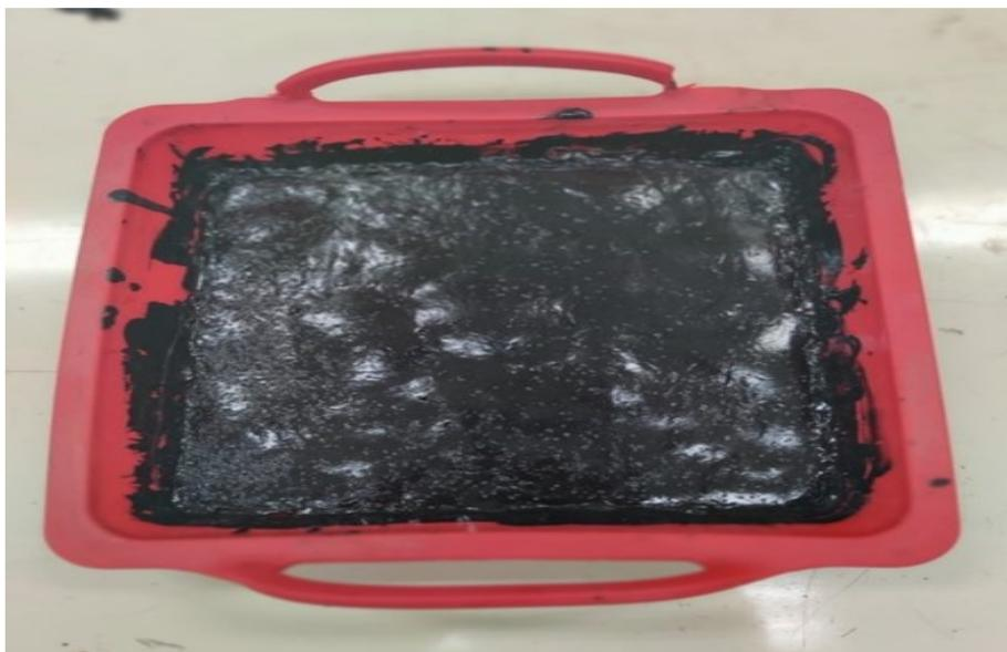
*Figura 4.8 – Mastice nello stampo a fine "cottura"*
