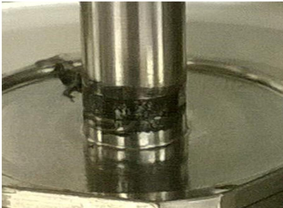
*Figura 4.27 – Campione dopo trimming*
