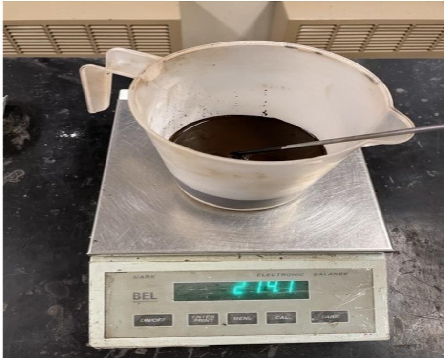
*Figura 4.4 – Contenitore con filler, acqua ed emulsione bituminosa*
