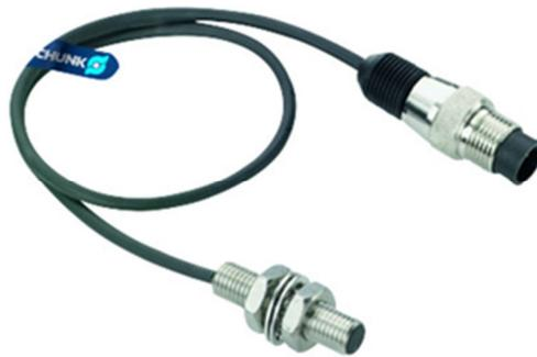
Figura 2.6. Sensore induttivo di prossimità
