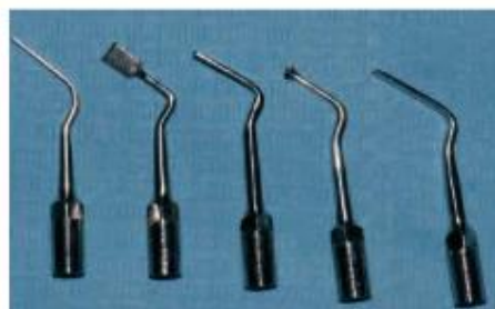
Figura 9 Le punte in titanio avvitate sul manipolo trasmettono più efficacemente le onde sonore rispetto all'acciaio medico e sono in grado di resistere maggiormente allo stress generato dagli ultrasuoni riducendo la possibilità di frattura delle stesse.
