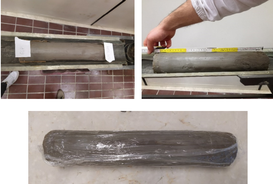
Figure 3.2.2 - Misurazione e copertura del campione
