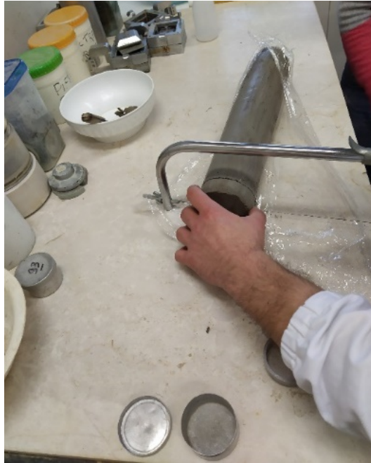
Figure 3.2.4 - Taglio porzione di campione
