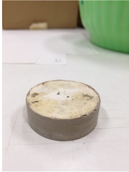
Figure 3.3.5 - Estrazione provino a prova ultimata e dopo essiccamento
