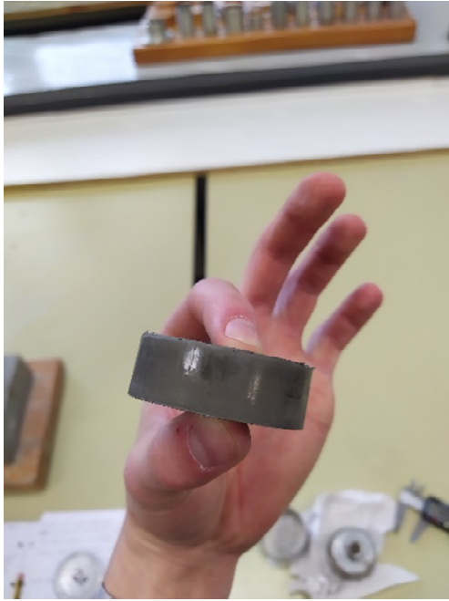
Figure 3.3.5 - Estrazione provino a prova ultimata e dopo essiccamento
