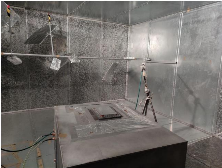
Figura 3.1 Interno di una camera riverberante con agitatore modale, antenna di misurazione e camera nested
