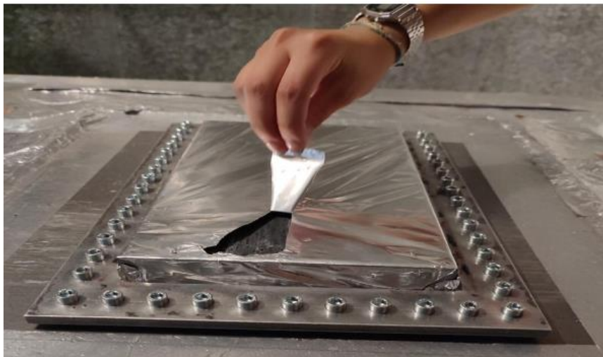
Figura 5.8 rimozione lamina metallica
