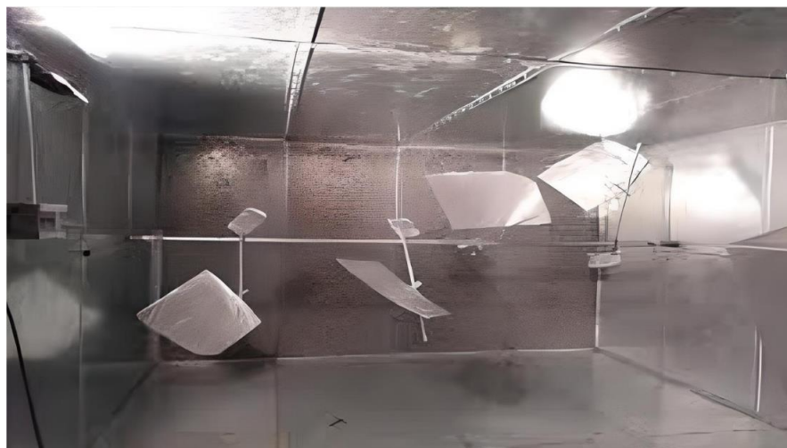
Figura 3.4 Camera riverberante con agitatori modali disposti orizzontalmente
