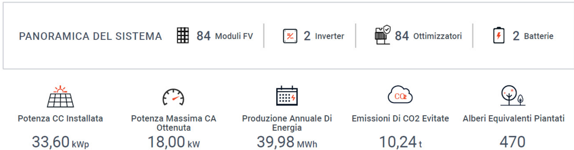
Figura 51: Composizione e dati di potenza dell'impianto fotovoltaico
