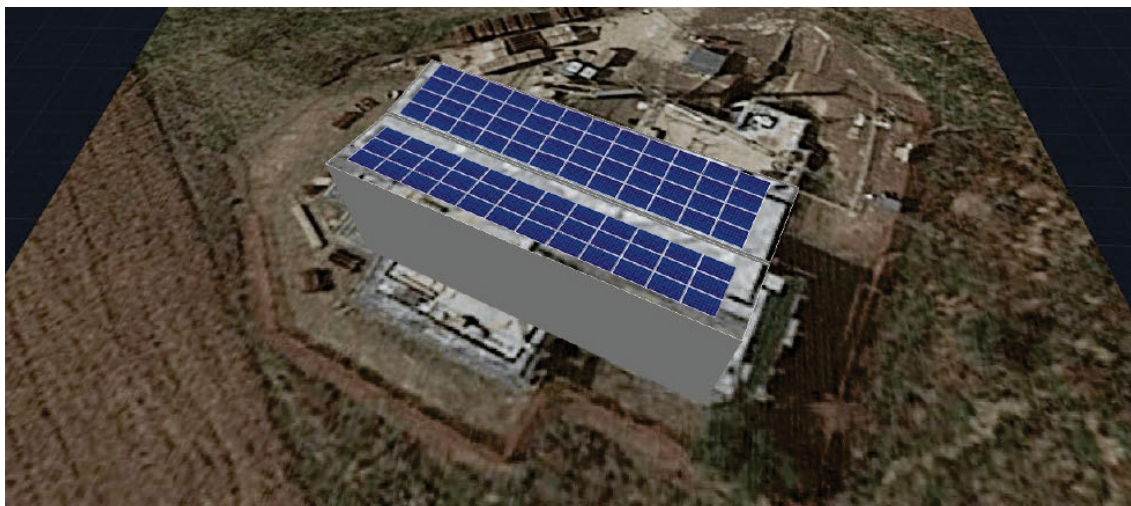
Figura 50: Distribuzione moduli fotovoltaici sulla copertura dell'edificio
