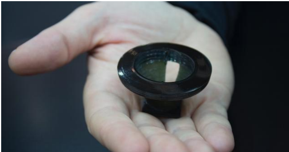
Fig. 6: Il primo pezzo prodotto da Chuck Hull tramite SLA [5]
