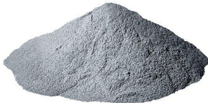
Fig. 9: Esempio di polvere metallica utilizzata nel PBF. [9]
