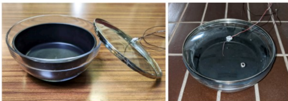
Figura 2.7 Ricevitore usato nelle prove, costituito da una tortiera in acciaio inox nero, una ciotola e un coperchio in vetro
