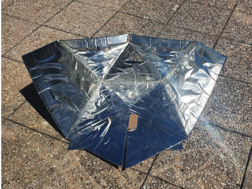
Figura 2.33 Configurazione del DSPC per elevate altezze solari
