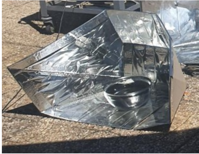
Figura 2.27 Configurazione del Fun-Panel per basse altezze solari
