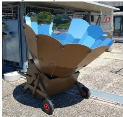
Figure 1.17 e 1.18 Forno solare a scatola portatile (a sinistra) e forno ad alta concentrazione con specchi riflettenti (a destra)
