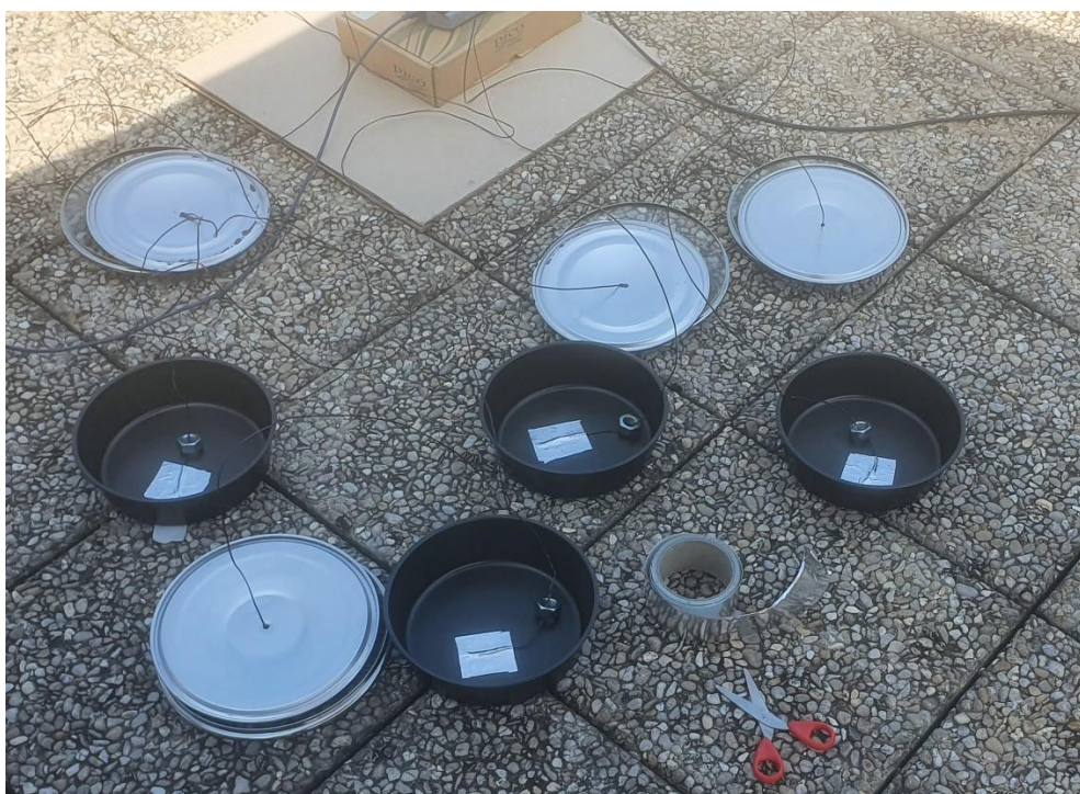
Fig. 5.6 Sistema di fissaggio delle termocoppie sul fondo delle tortiere nere
