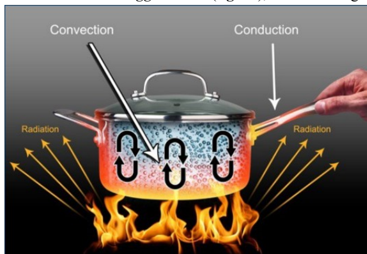
Figura 2.2 Modalità di trasmissione del calore in una pentola
