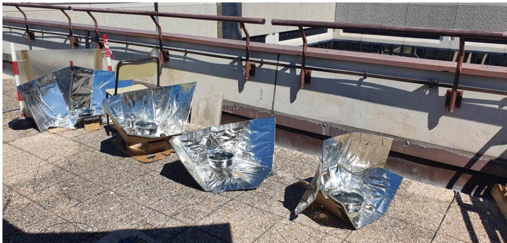
Figure 3.16 Forni posti in prossimità del parapetto per proteggerli dal vento
