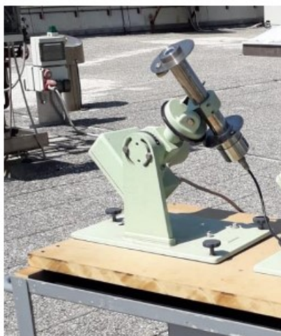
Fig. 3.1 Pireliometro NIP utilizzato
