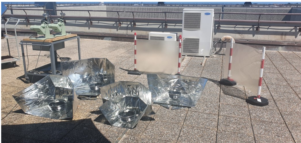
Figura 3.14 Sistemi di schermatura dal vento con pannelli di plexiglass
