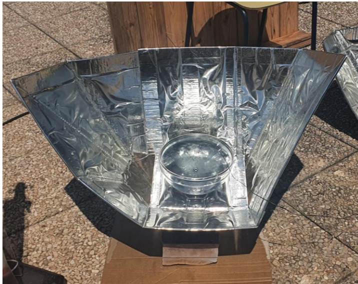
Figura 2.28 Configurazione del Fun-Panel per elevate altezze solari
