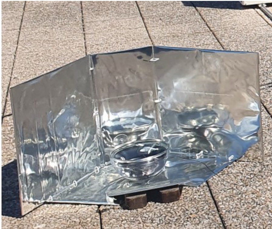
Figura 2.16 Configurazione del Kimono per basse altezze solari
