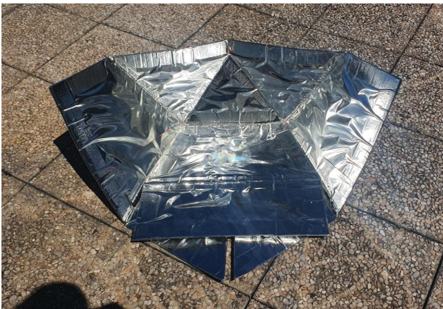
Figura 2.32 Configurazione del DSPC per basse altezze solari
