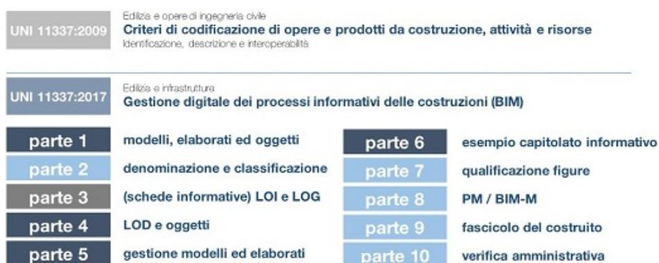
Figura 4 - Struttura della norma UNI 11337
