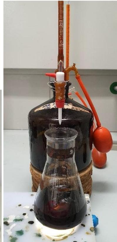
*Fig.17–Bilancia per la pesata dei campioni, trasferiti poi in beute. Fig.18 –Titolazione con sale di Mohr.*
