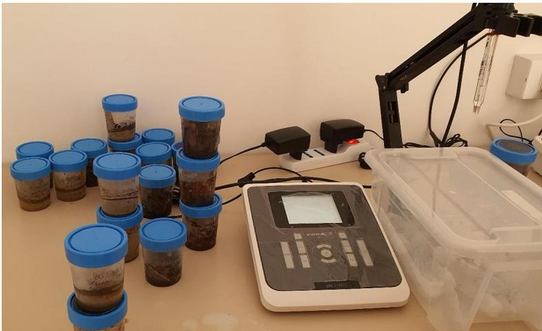
*Fig.13 – A sinistra i contenitori con campioni, a destra strumentazione per la misura del pH.*
