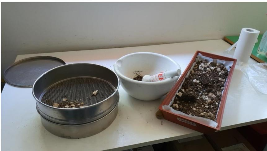
*Fig.10 – Frantumazione in mortaio e setacciatura a 2 mm del suolo minerale.*
