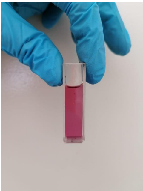
Figura 25: Cuvetta in quarzo con all'interno un campione su cui si è effettuata reazione di o-DPO con conseguente colorazione violacea della soluzione.
