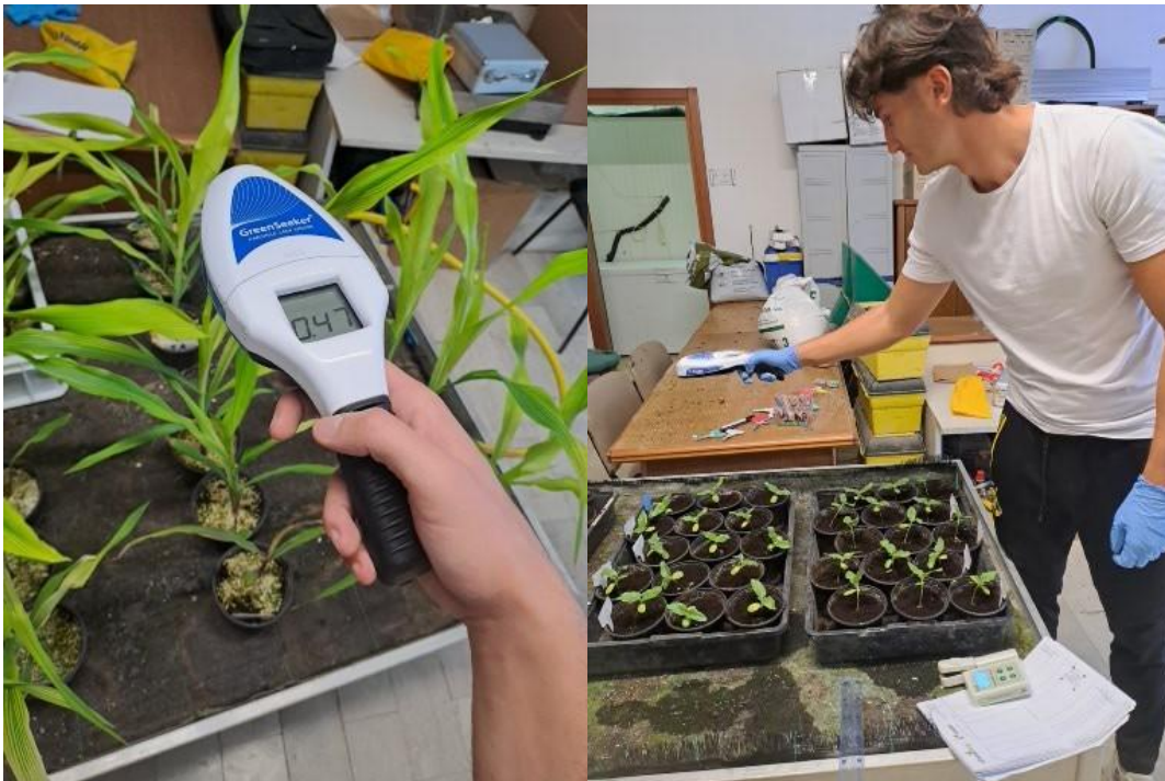
Figura 15: Misurazioni dell'indice NDVI mediante il GreenSeeker. Rilievo su piante di Mais (sx); rilievo su piante di girasole (dx).
