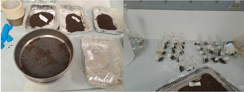
Figura 22: Setacciamento dei suoli a 2 mm (sx); pesatura di 0,25 gr per replica e trasferimento in beute di vetro di 100 ml (dx).
