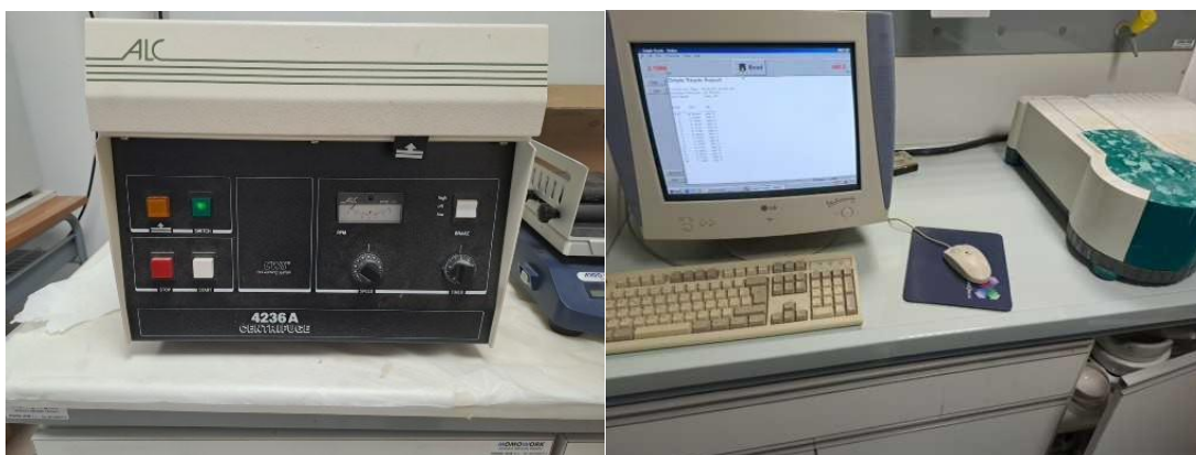
Figura 24: Centrifuga utilizzata nella prova (sx); spettrofotometro (dx).
