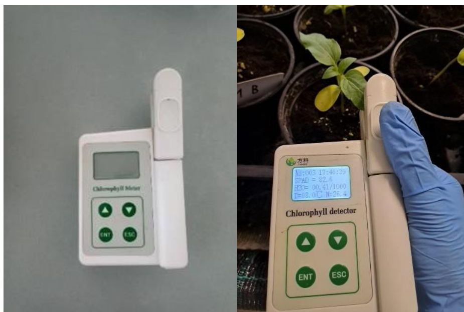
Figura 14: SPAD (Chlorophyll Meter) utilizzato nella prova; nella foto a destra si può notare il rilievo eseguito su una piantina di girasole.
