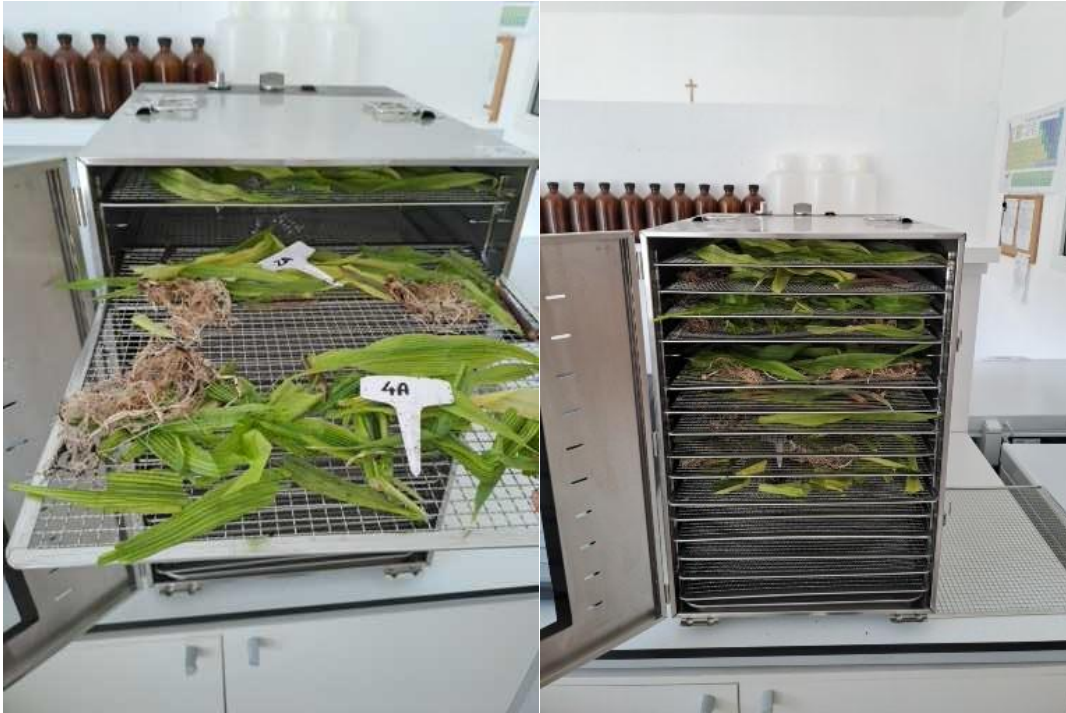
Figura 20: Essiccazione della biomassa epigea ed ipogea di piantine di mais a 70 °C fino a peso costante, effettuata nel laboratorio all'interno del centro di saggio Res Agraria.
