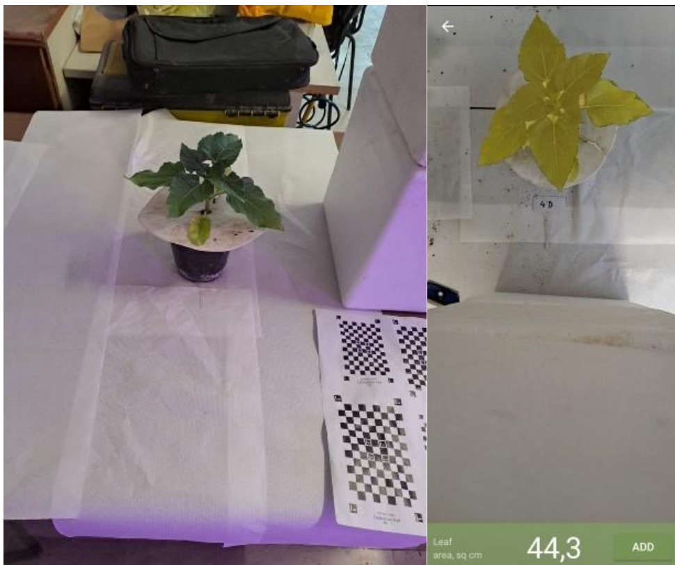
Figura 16: Rilevazione dell'area fogliare mediante lo strumento "Petiole": foglio di calibrazione utilizzato prima di ogni misurazione (sx alto); rilevazione ad un'altezza prestabilita su piantina di girasole, sfondo bianco per permettere l'esclusiva valutazione degli organi verdi (dx alto, sx basso); visualizzazione
