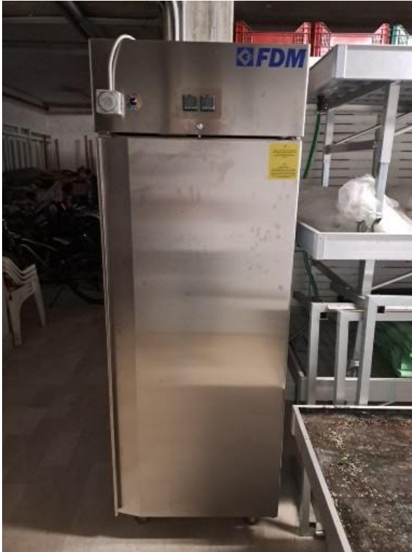
Figura 11: Congelatore da laboratorio FDM utilizzato per mantenere 48 ore le piantine di mais e girasole a 0°C.
