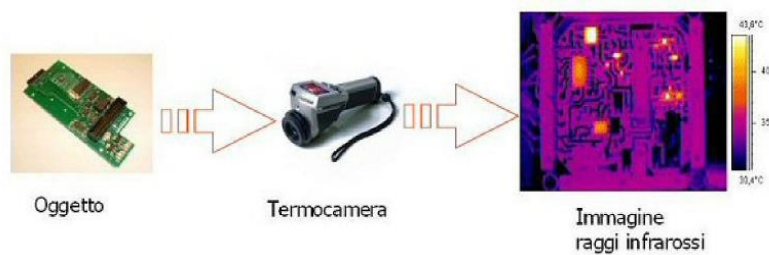
Figura 4.9: Processo termografico tramite termocamera
