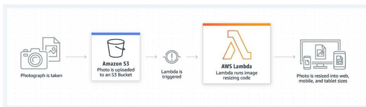
**Figura 2.32:** Esempio di utilizzo di una funzione Lambda con Amazon S3
