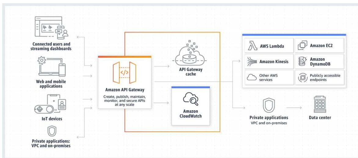
Figura 2.26: Schema dell'architettura di API Gateway
