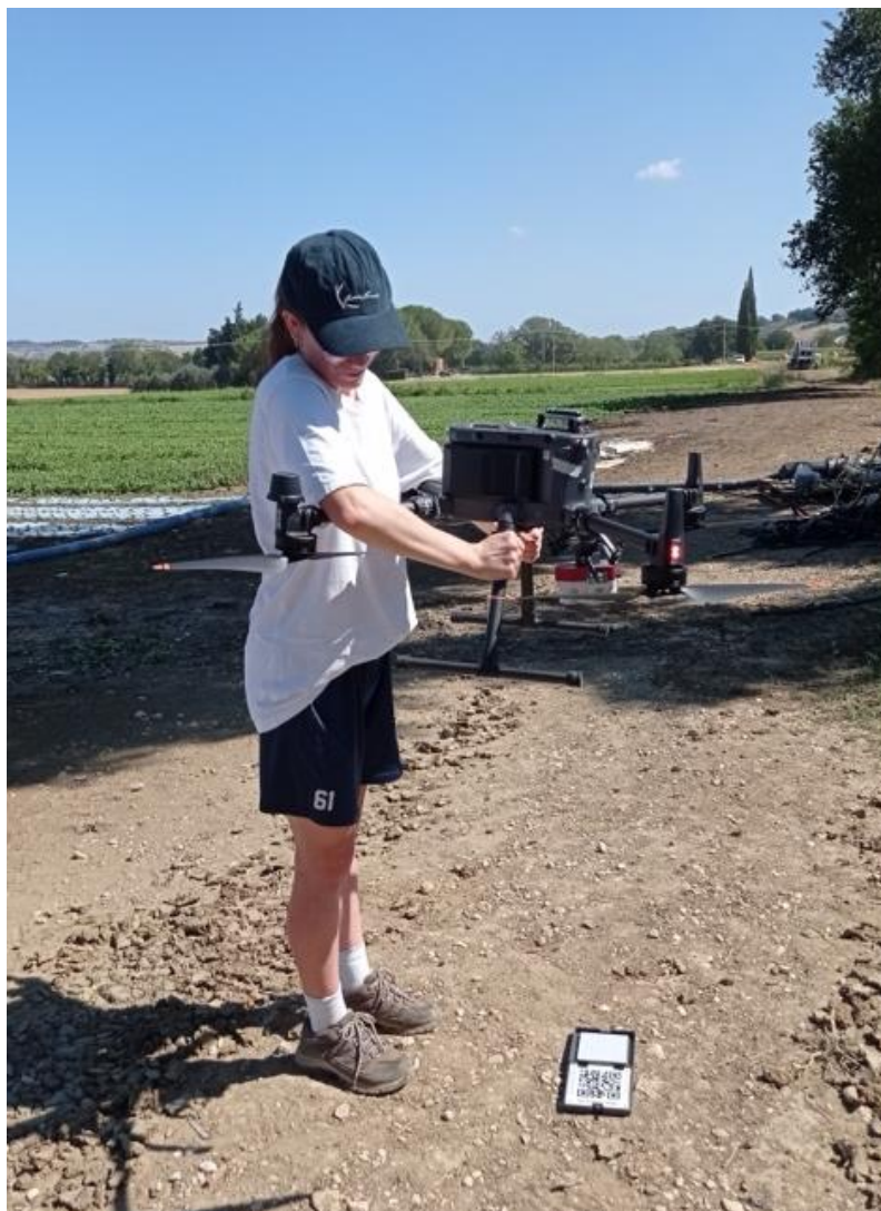
Figura 6-12: Operazione di calibrazione della camera spettrale
