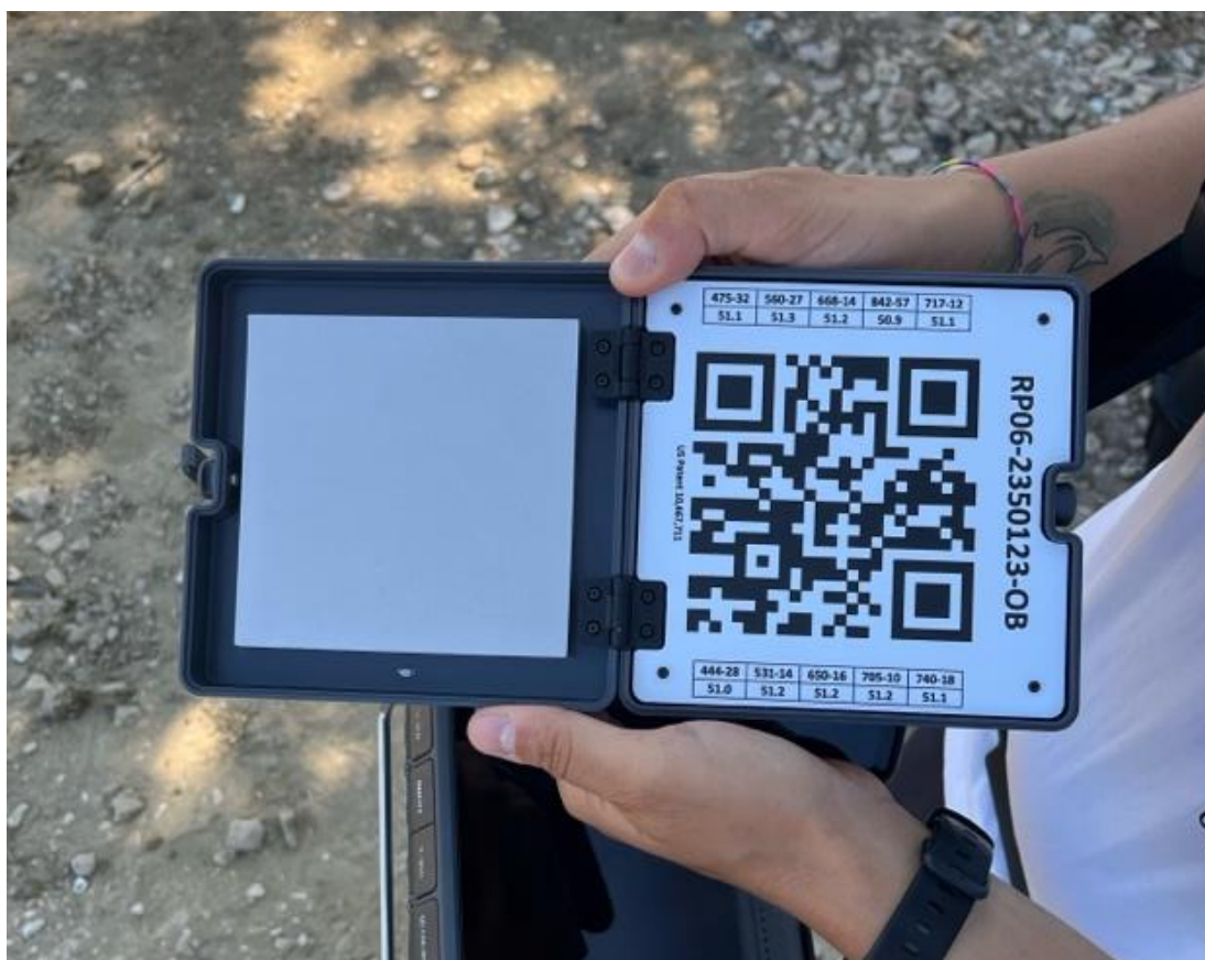
Figura 6-11: Pannello bianco puro per calibrazione iniziale e finale del drone
