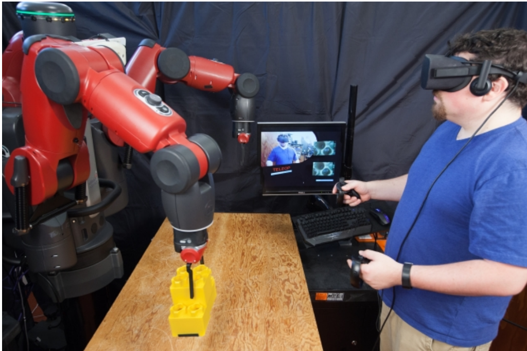
Figura A.3 Assemblaggio Robot-Operatore tramite AR System
