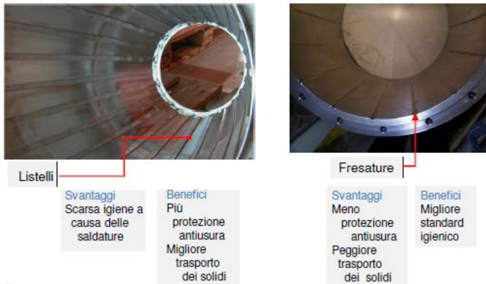
Figura 21 - esempi di differenti lavorazioni interne al tamburo
