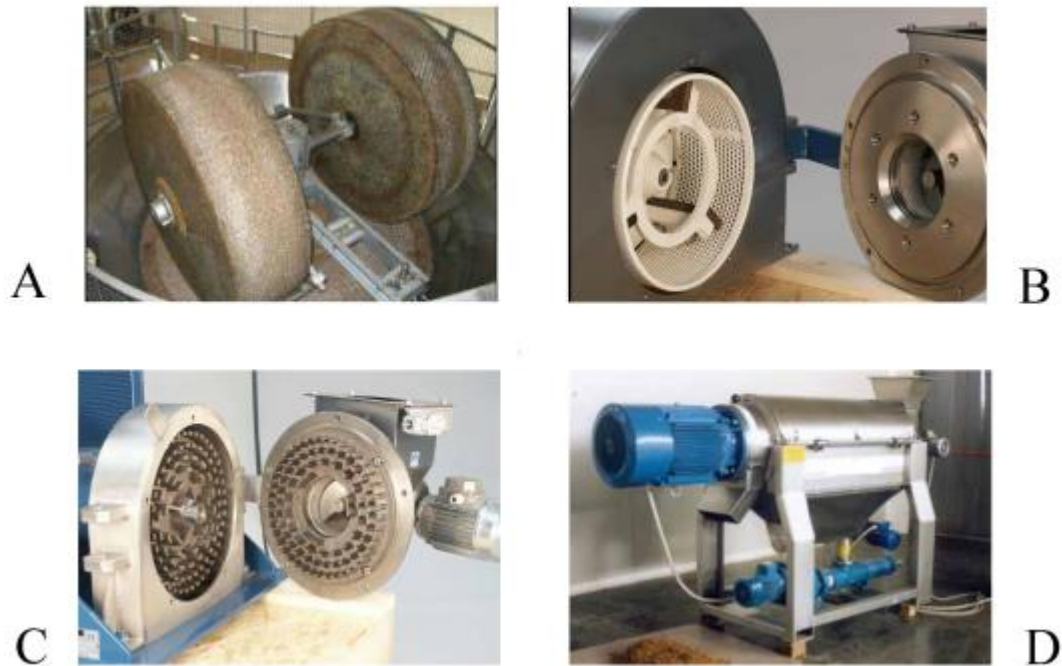
Figura 3- "A"frangitore a molazze "B" frangitore a martelli, "C" frangitore a dischi, "C" denocciolatore
