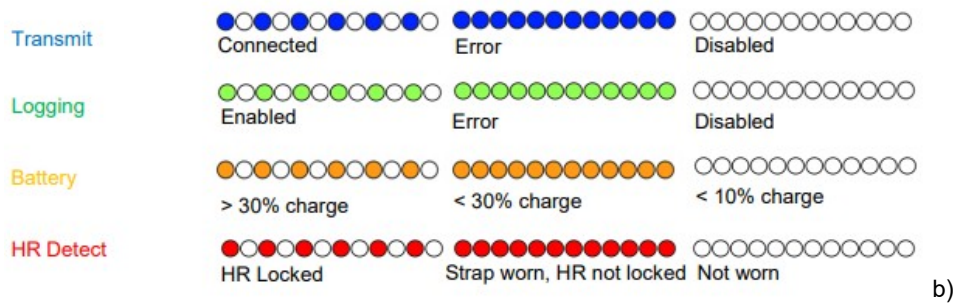
Figura 28: a) trasmissione dei dati in modalità di monitoraggio; b) comportamento dei LED per definire lo stato del sistema durante il monitoraggio
