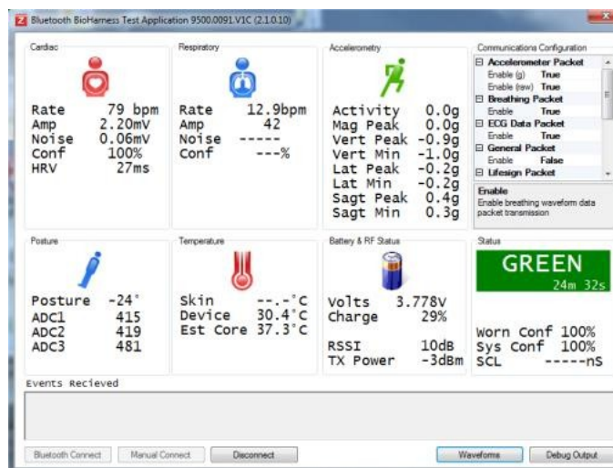
Figura 26: applicazione test Bluetooth, mostra un riassunto di tutti i parametri fisiologici
