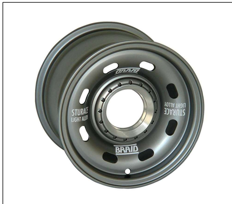
Fig. 2: L'attuale cerchio montato sulla P4M.
