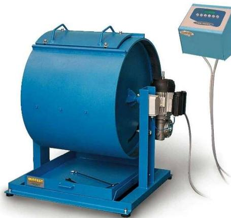
*Fig.7 Cilindro della prova Los Angeles*
