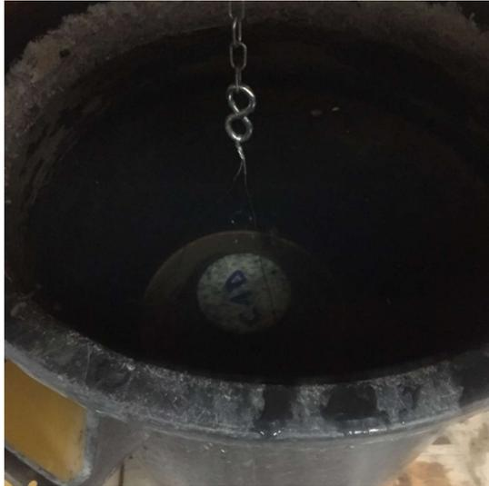
Fig.40 Pesatura del provino immerso in acqua
