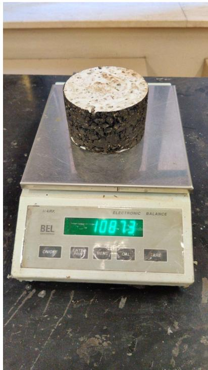
Fig. 39 Pesatura del provino
