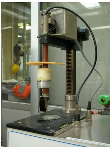
Fig.23 Apparecchiatura prova Frass
