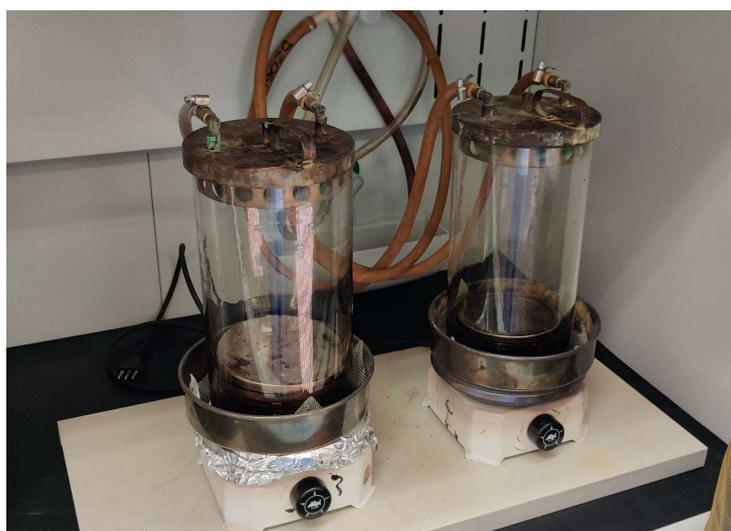
*Fig.35 Strumento per il calcolo della percentuale di bitume*
