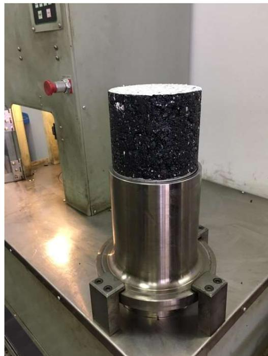
Fig. 38 Provino che ha subito il processo di compattazione
