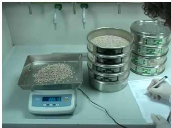
*Fig.30 Pesatura del trattenuto e passante di ogni setaccio*
