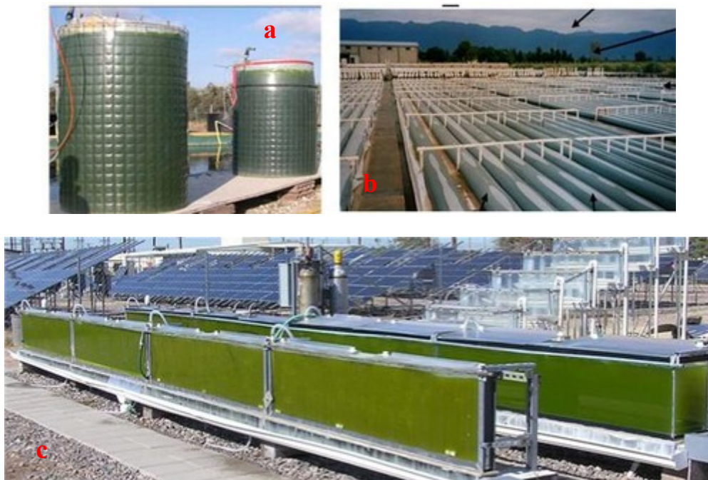
Figura 5 Fotobioreattori chiusi: verticale (a), orizzontale (b) e planare (c). Modificato da Shen et al., 2009
