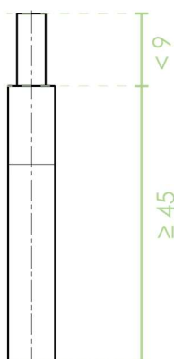
Figura 37, Sonda descritta nella norma UNI EN 196-3
