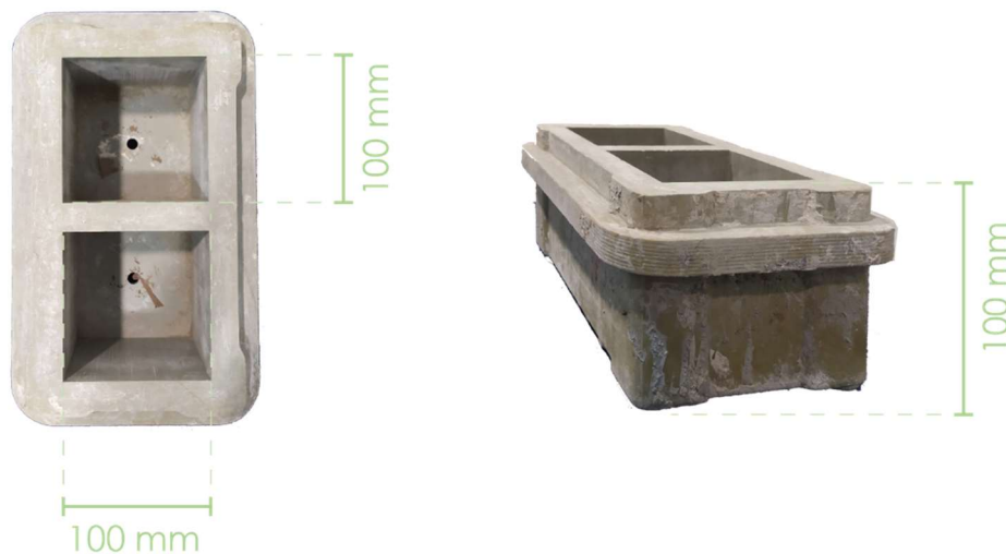
Figura 48, I casseri di dimensioni 100*100*100 mm utilizzati per il getto delle miscele di cls
