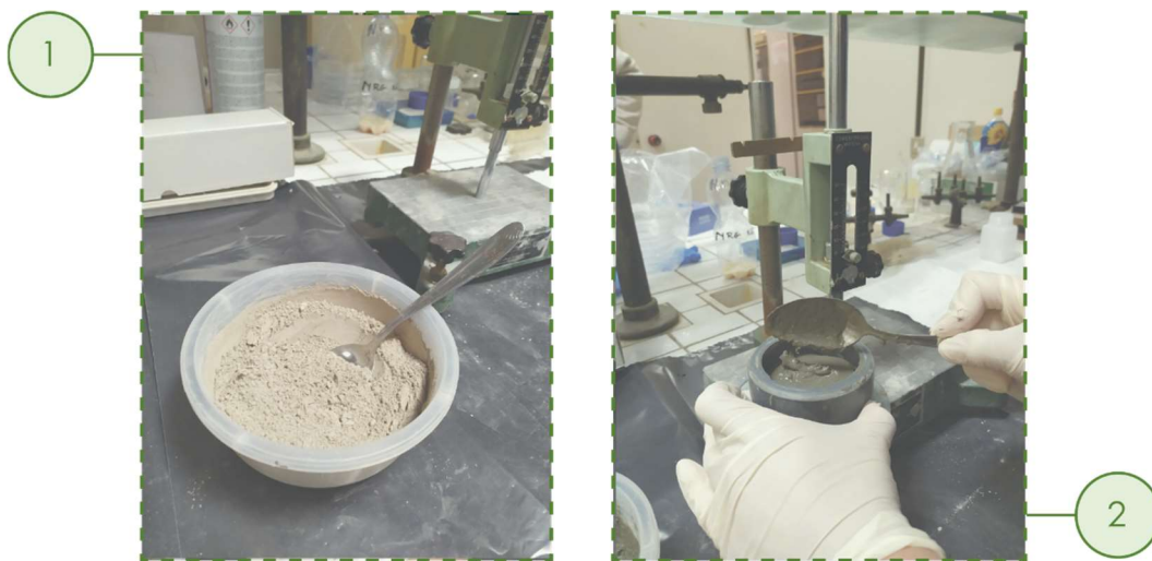
Figura 38, Determinazione della consistenza della miscela: preparazione dell'impasto
