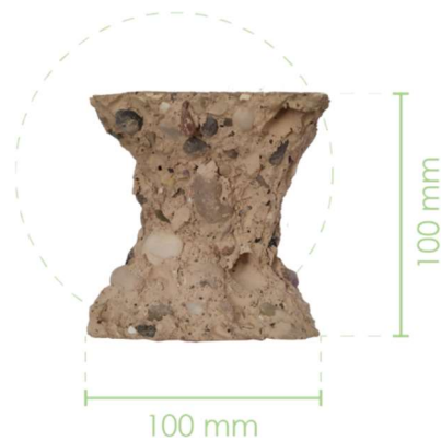
Figura 51, Il provino, dopo la rottura a compressione, acquisisce la conformazione "a clessidra"
