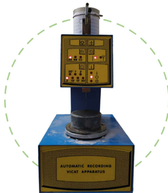
Figura 40, Apparecchiatura di Vicat automatica utilizzata per la prova
