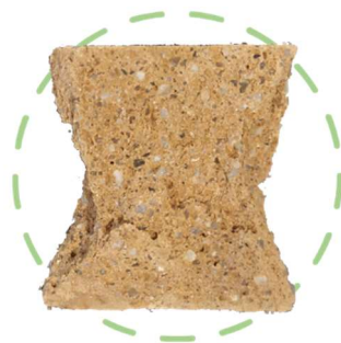
Figura 34, La " clessidra" , la tipica forma del provino dopo aver effettuato la rottura a compressione
