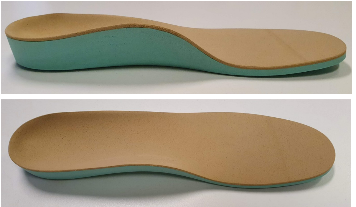
Figura 4.8: Plantare di riferimento realizzato con campioni EVA.
