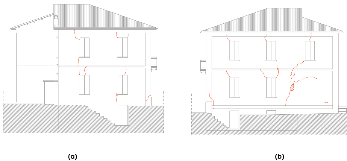
Figura 3.39: Rilievo del quadro fessurativo: prospetto est (a) e prospetto ovest (b)
