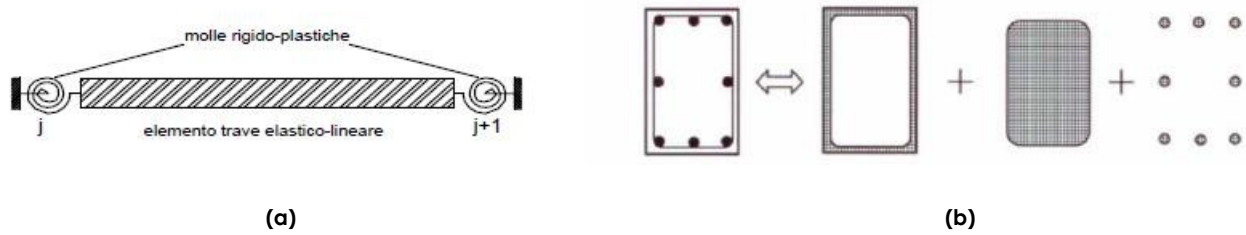
Figura 4.22: schematizzazione della modellazione a plasticità concentrata (a) e della modellazione a fibre (b)
