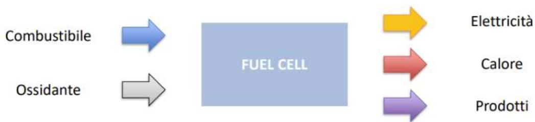
FIGURA 24 SCHEMA DI FUNZIONAMENTO PER UNA CELLA A COMBUSTIBILE
